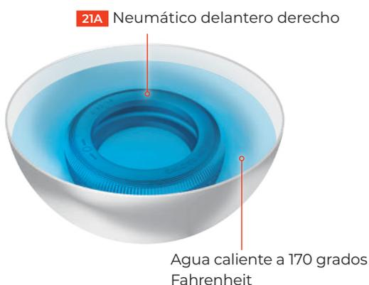
El neumático delantero derecho **21A** es difícil de doblar a temperatura ambiente, y es difícil presionarlo sobre la llanta. Se recomienda colocarla en un recipiente con agua caliente (aprox. 170 °F / 75 °C) durante unos minutos. Cuando se caliente, se ablandará y podrá montarse fácilmente.
