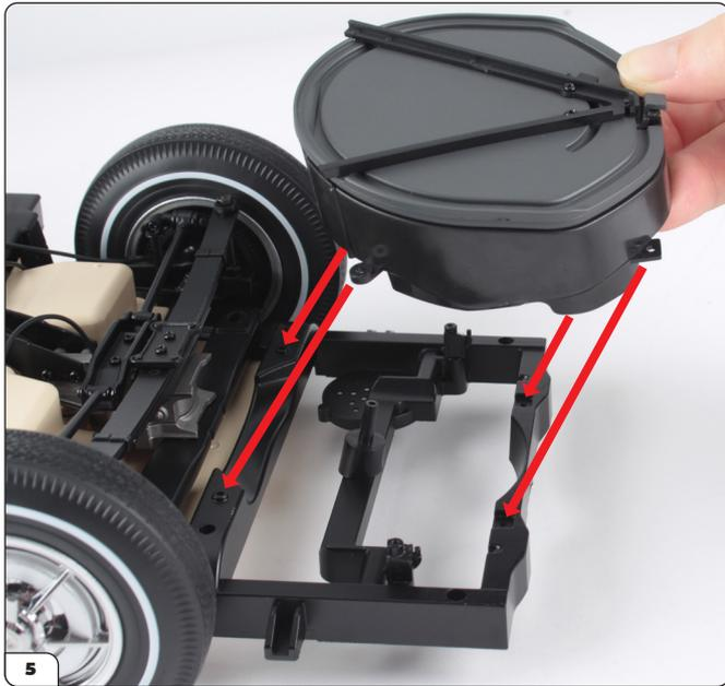
Encaje las lengüetas moldeadas del soporte de la rueda de repuesto en los orificios para tornillos y en el rebaje rectangular del chasis (flechas).
