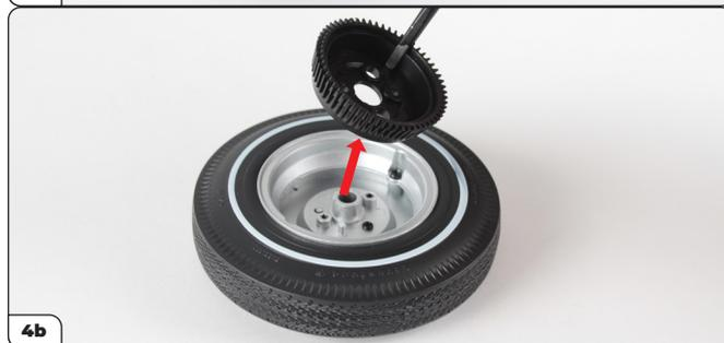
Remueva la rueda del cubo y luego desatornille los tornillos RM (imagen 4a). Guarde los tornillos en un lugar seguro. Retire el tambor de freno (imagen 4b).
