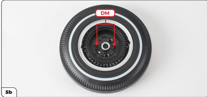
Monte el tambor de freno en la rueda que acaba de montar, usando el pasador de fijación (rodeado con un círculo) como guía (imagen 5a). Asegure el tambor usando 2 tornillos DM (imagen 5b).
