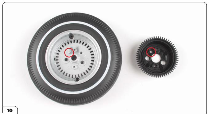
Alinee el tambor de freno con la rueda que acaba de montar, usando el pasador de montaje y el orificio como guía (rodeados con un círculo).
