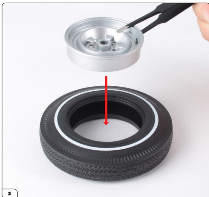
Para ensamblar la rueda de repuesto original del '63, encaje la llanta externa en el neumático (flecha).
