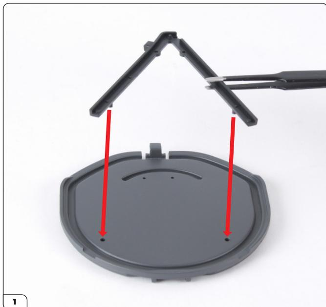
Encaje los pasadores de la barra de refuerzo en los orificios de la tapa (flechas).
