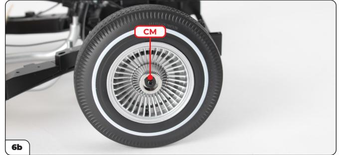
Encaje la nueva rueda en el cubo y luego coloque la arandela sobre la columna para tornillos (imagen 6a). Asegure la rueda usando un tornillo CM (imagen 6b).
