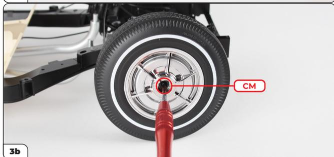
Retire el tapón giratorio de tres barras de la rueda delantera original (imagen 3a). Luego, desatornille el tornillo CM y la arandela que tienen la rueda en su lugar (imagen 3b). Guarde las piezas retiradas en un lugar seguro.
