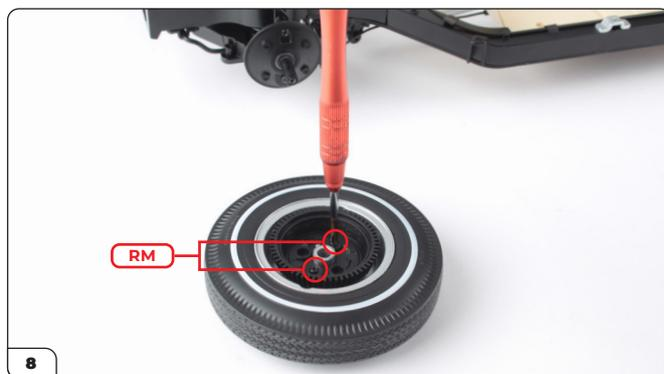
Capovolgì la ruota e svita le viti RM che fissano il tamburo del freno.
