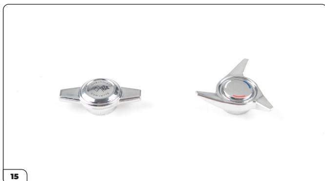
Scegli il tipo di gallettone da utilizzare. Se stai costruendo un veicolo di serie autentico: i gallettoni a tre alette sono stati utilizzati sulle ruote di serie del '64 fornite in questa fase. I gallettoni a due alette sono invece quelli delle ruote del '63 fornite nelle confezioni precedenti.
