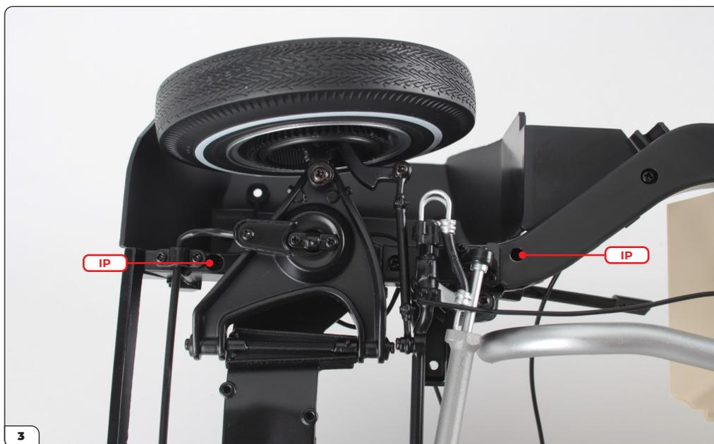
Capovolgi il telaio, quindi inserisci e avvita due delle viti IP nei relativi fori.
