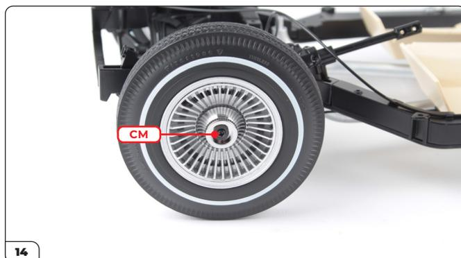
Fissa la ruota utilizzando una vite CM.
