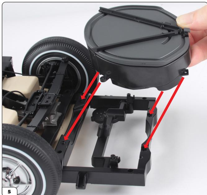
5 Monta l'alloggiamento della ruota di scorta sul riquadro posteriore del telaio facendo coincidere i fori dei relativi supporti.
