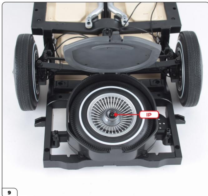
Fissa la ruota di scorta usando una delle viti IP.
