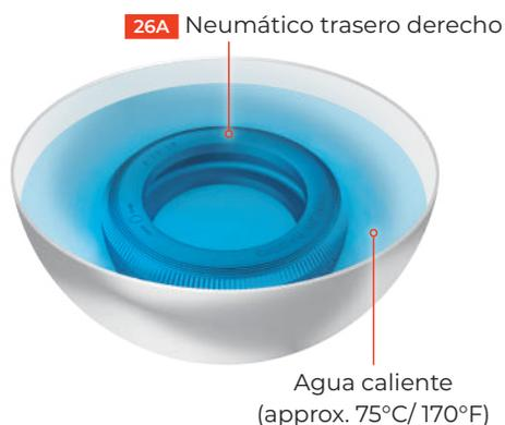
El neumático trasero derecho 26A es difícil de doblar a temperatura ambiente, y es difícil presionarlo sobre la llanta. Se recomienda colocarlo en un recipiente con agua caliente (aprox. 75 °C/ 170 °F) durante unos minutos. Cuando se caliente, se ablandará y podrá montarse fácilmente.
