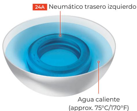
El neumático trasero izquierdo 24A es difícil de doblar a temperatura ambiente, y es difícil presionarlo sobre la llanta. Se recomienda colocarlo en un recipiente con agua caliente (aprox. 170 °F/75 °C) durante unos minutos. Cuando se caliente, se ablandará y podrá montarse fácilmente.
