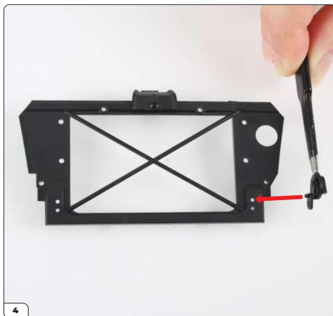
4 Encaje la bocina izquierda ('L') colocando su pasador en el casquillo del bastidor, como se muestra en la imagen.
