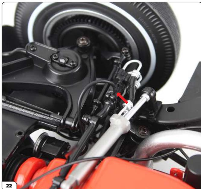
Encaje el cable en el pasador interno de la barra central de dirección.
