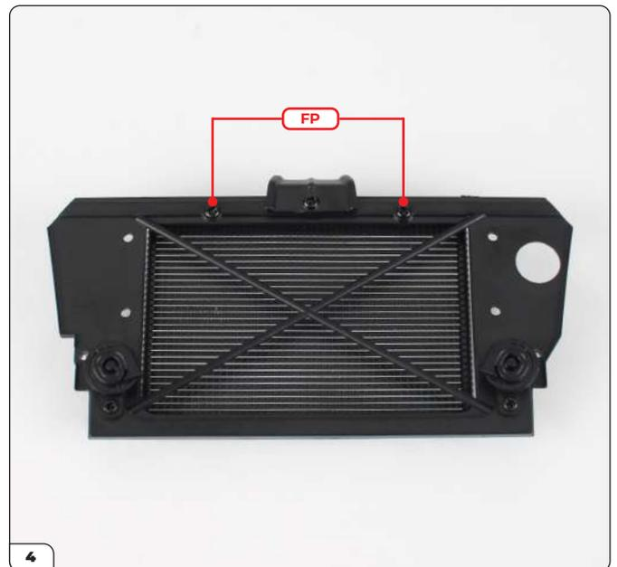
Dé la vuelta al montaje y asegure el radiador usando 2 tornillos FP.
