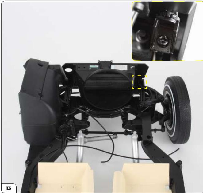
Una vez colocado en su sitio, el bastidor debe encajar como se muestra en la imagen, con los postes para tornillos conectados a los soportes (recuadro).
