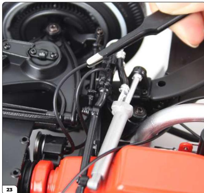
Localice el extremo suelto del cable de 62 mm que fue encajado en la bomba de dirección en la etapa 47.
