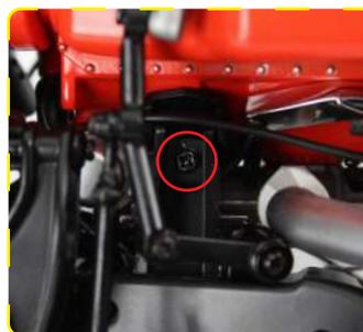
Introduzca 2 tornillos CM a través de los soportes del motor para mantenerlo en su lugar. Las imágenes de los recuadros muestran más de cerca los tornillos (rodeados con un círculo).
