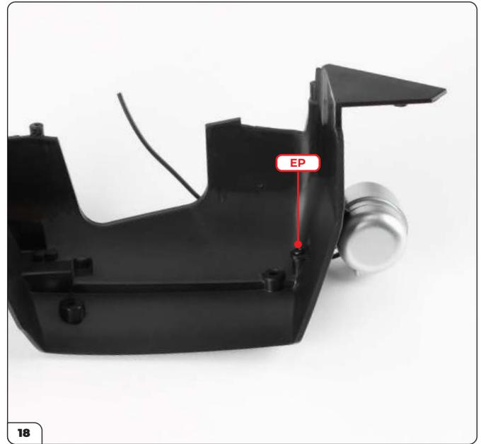
Asegure el depósito usando un tornillo EP.
