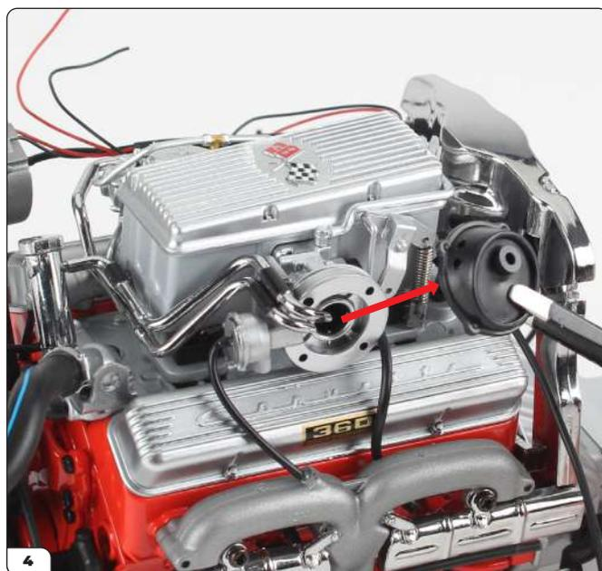
Retire el cono difusor del montaje, como se muestra en la imagen.
