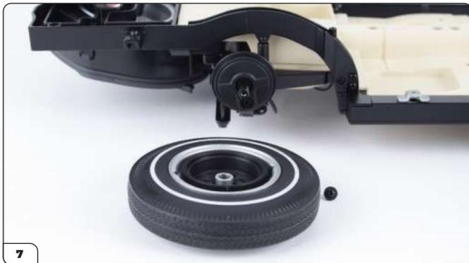
Retire la rueda y guarde en un lugar seguro el tornillo, la arandela y el tapón giratorio de tres barras. Coloque la rueda sobre su superficie de trabajo, como se muestra en la imagen.
