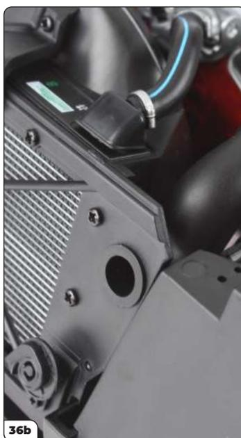
Ajuste el tubo del colector de admisión de manera tal que el extremo abierto este alineado con el orificio del bastidor de refuerzo. Luego, introduzca la fijación del tubo del colector de admisión para mantenerlo en su sitio (imagen 36a). Presione firmemente hasta que la fijación quede enrasada (imagen 36b).
