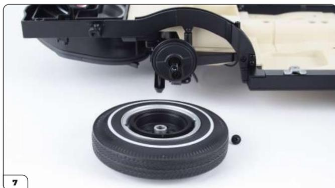
Retirez la roue, puis mettez la vis, la rondelle et le tourniquet trois barres de côté. Placez la roue sur la surface de travail tel qu'indiqué.
