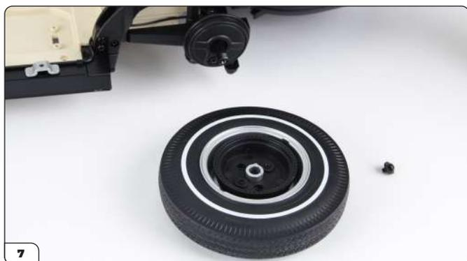
7 Retirez la roue, puis mettez la vis, la rondelle et le tourniquet trois barres de côté. Placez la roue sur la surface de travail tel qu'indiqué.
