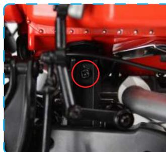
Enfoncez 2 vis CM dans les supports du moteur pour maintenir ce dernier en place. Les images présentées en encadré offrent une vue plus détaillée des vis (entourées).
