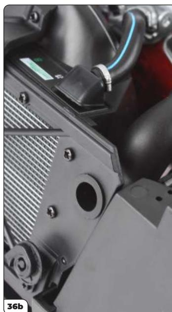
36a Ajustez le tuyau du collecteur de sorte que l'extrémité ouverte s'aligne sur le trou du cadre de renfort, puis insérez la fixation du collecteur d'admission pour la maintenir en place (36a). Appuyez fermement jusqu'à ce que la fixation affleure (36b).
