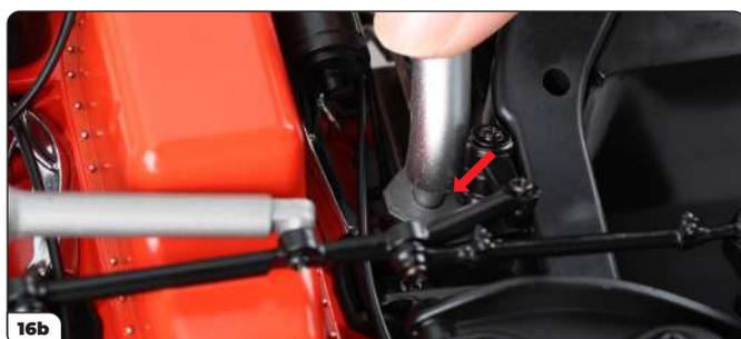
Soulevez le tuyau d'échappement puis retirez le film de protection de l'autocollant posé sur le collecteur à l'aide d'une pince à épiler (16a). Enfoncez fermement la broche du tuyau dans le trou du collecteur (16b).
