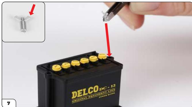
Enfoncez l'une des vis papillon dans le trou situé à l'extrémité de la rangée de bouchons. Veillez à ne pas endommager les petites « ailes » de la pièce lors du montage (cf. encadré).
