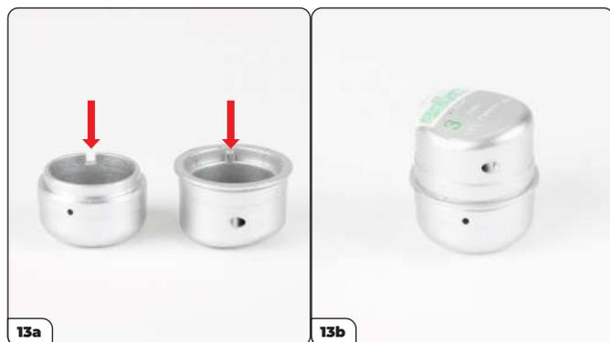
Placez les moitiés gauche et droite du réservoir de liquide de refroidissement sur votre plan de travail et repérez la languette de montage et le renforcement correspondant (13a). Utilisez ces derniers pour vous guider lorsque vous pressez les deux moitiés l'une contre l'autre (13b).
