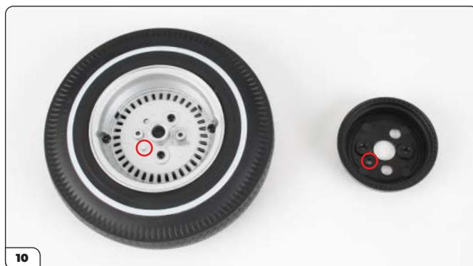
Alignez le tambour de frein avec la roue nouvellement assemblée en vous guidant avec la goupille de fixation et le trou.
