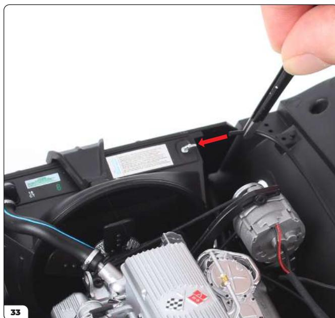
Branchez l'extrémité libre du câble du réservoir de liquide de refroidissement dans le connecteur de tuyau d'eau sur le cache de ventilateur (cf. flèche).
