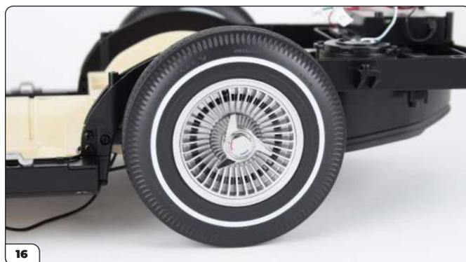
Appuyez sur celle-ci pour la mettre en place, tel qu'indiqué. L'élément est maintenu par un aimant.
