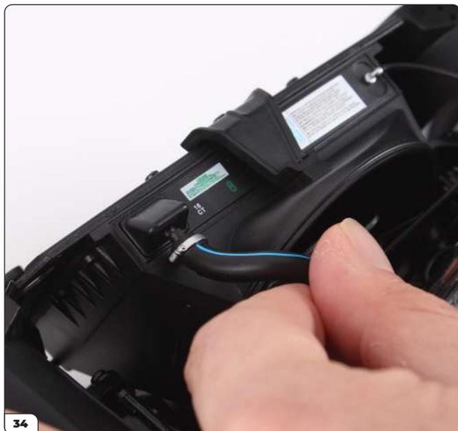
34 Poussez l'extrémité du flexible d'eau dans son connecteur. Appliquez une goutte de colle si le flexible est mal fixé sur le moteur.
