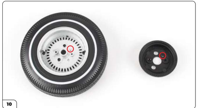
Monta il tamburo del freno all'interno del cerchio della nuova ruota, usando come riferimento il perno e il foro sui rispettivi pezzi.
