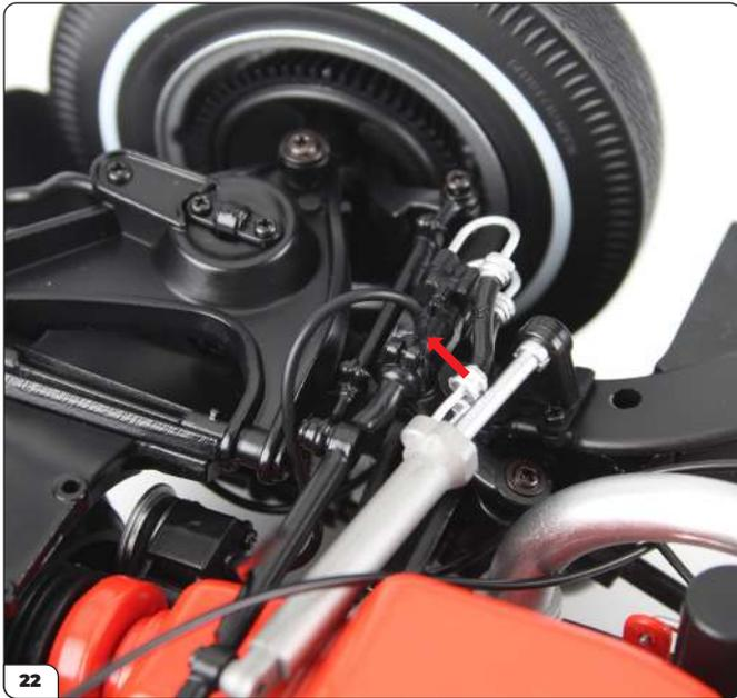
Monta il cavo sul perno che si trova sul lato interno della barra centrale dello sterzo.
