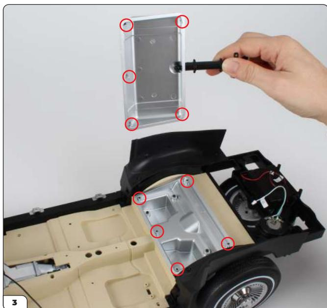
Posiziona la parte superiore del serbatoio su quella inferiore, allineando i fori dei rispettivi attacchi.
