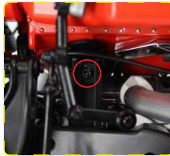
Fissa il motore sui suoi supporti utilizzando due viti CM. Le due viste ingrandite sulla destra mostrano dove devono essere montate le viti.
