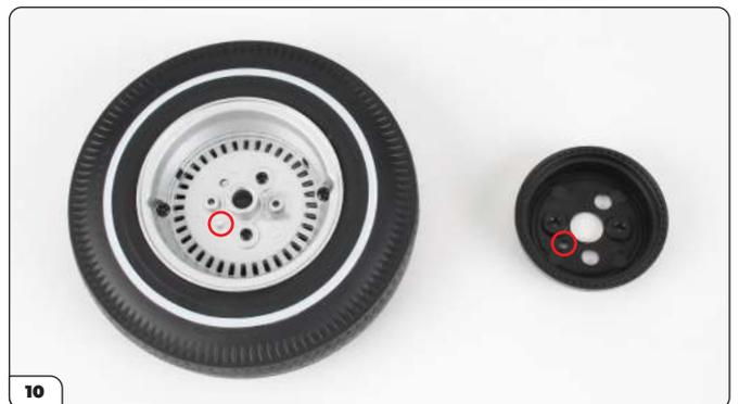
10 Monta il tamburo del freno all'interno del cerchio della nuova ruota, usando come riferimento il perno e il foro sui rispettivi pezzi.
