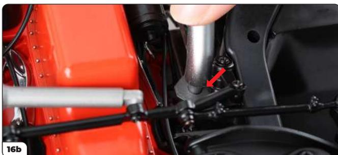
Scosta uno dei tubi di scarico dal collettore, quindi togli la pellicola superiore dell'etichetta biadesiva incollata all'uscita del collettore usando una pinzetta (foto 16a). Premi con decisione l'estremità del tubo di scarico dentro il foro del collettore (foto 16b).
