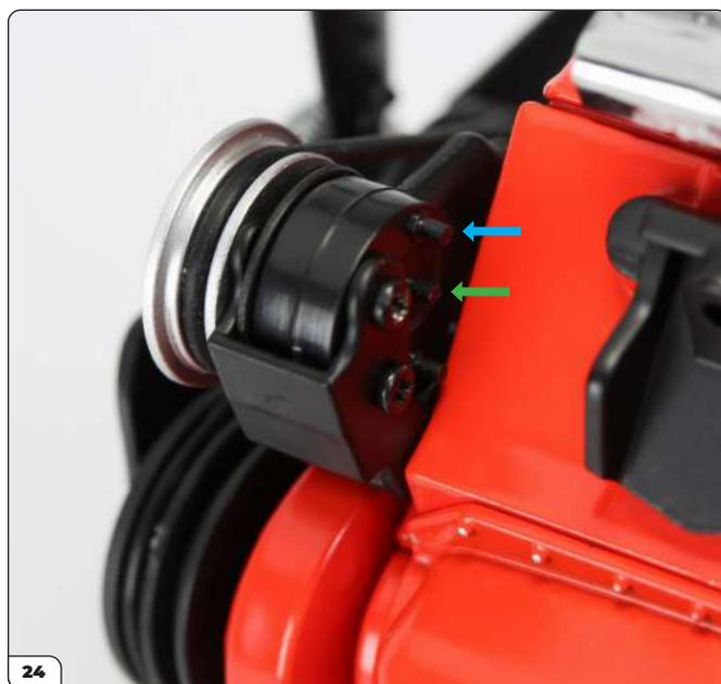
Riprendi il motore e individua i tre perni sul coperchio della pompa dello sterzo. Tieni conto dei due colori delle frecce; ti serviranno nelle fasi successive.
