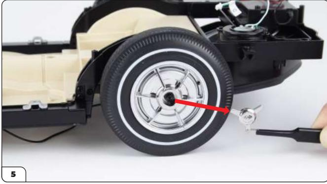
Per montare la nuova ruota, comincia a smontare il gallettone a tre alette che fissa la ruota d'origine.
