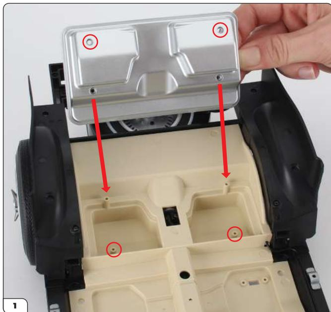
Monta il serbatoio sul pianale, allineando i corrispondenti fori per le viti.
