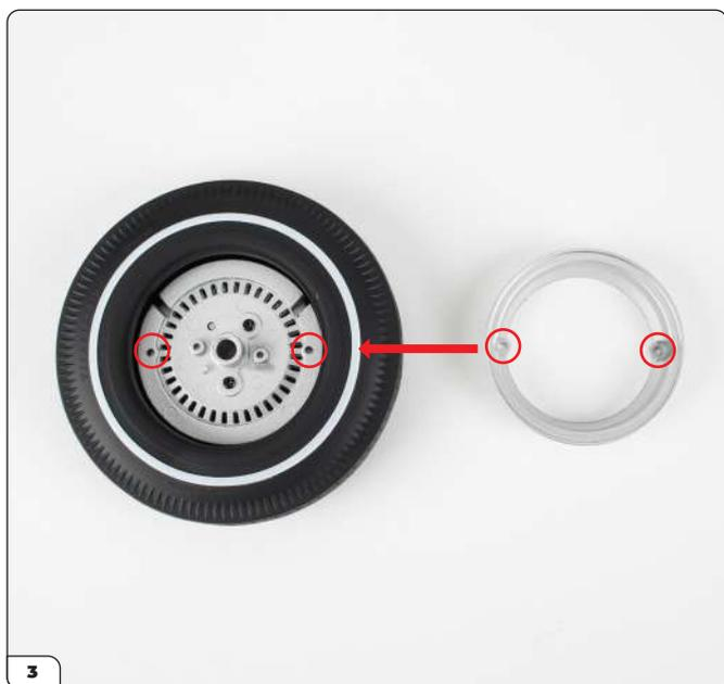
Capovolgi la ruota e monta l'anello interno del cerchio allineando i fori per le viti.
