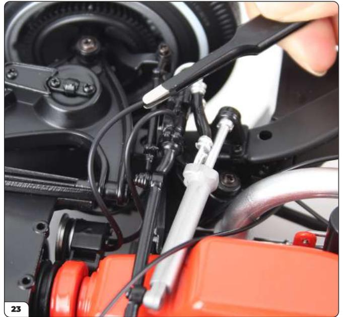
Individua l'estremità libera del cavo da 62 mm montato sul coperchio della pompa dello sterzo nella fase 47.
