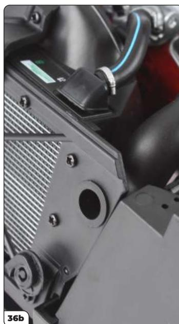
Sistema il condotto di aspirazione in modo che la sua imboccatura libera sia allineata con il foro presente sul telaio ausiliario, indicato dalla freccia, quindi collegalo fissandolo tramite la boccola (foto 36a). Premi a fondo la boccola nel condotto fino a ottenere un collegamento solido (foto 36b).
