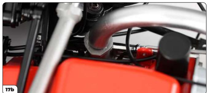
Ripeti l'operazione per il collettore sul lato opposto, togliendo la pellicola protettiva dalla relativa etichetta (foto 17a) e premendo con decisione il tubo di scarico nel foro del collettore (foto 17b).
