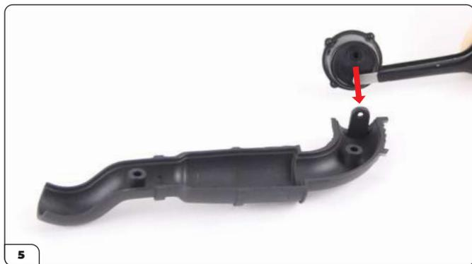
Monta il diffusore conico sull'imboccatura della metà inferiore del condotto di aspirazione.
