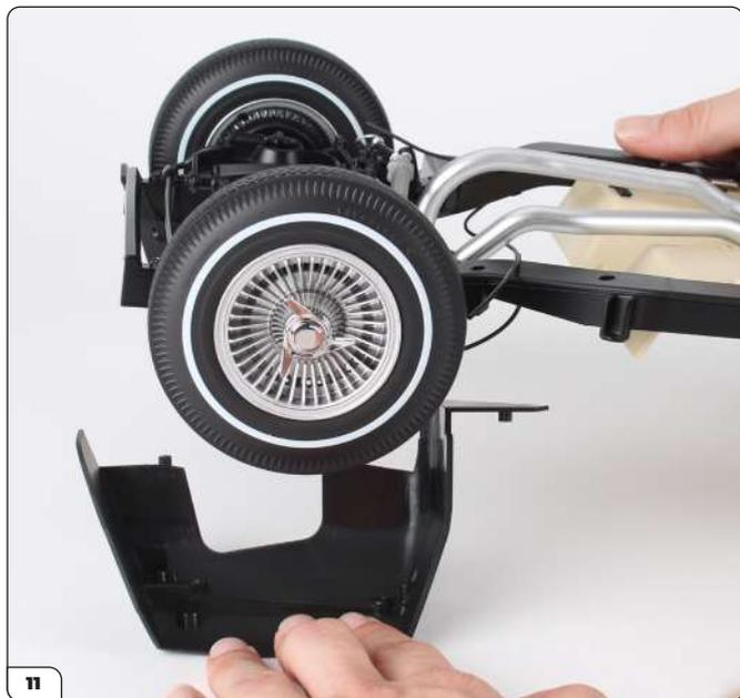
Una volta rimosse le viti, smonta con delicatezza dal telaio il passaruota anteriore destro e mettilo da parte.
