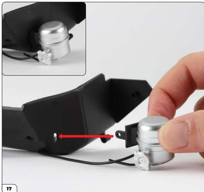
Monta il serbatoio del liquido refrigerante sul passaruota inserendo la staffa nel relativo intaglio.
