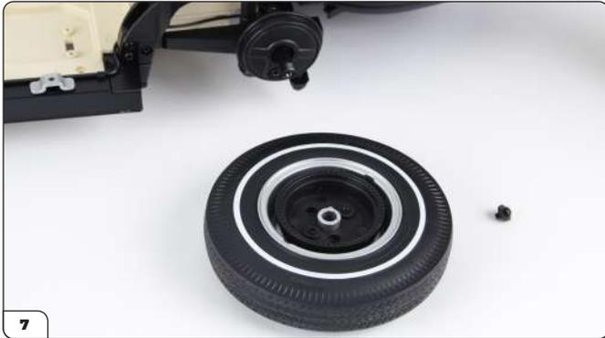
Smonta la ruota e metti da parte la vite, la rondella e il gallettone a tre alette. Appoggia la ruota sul piano di lavoro come mostrato nella foto.
