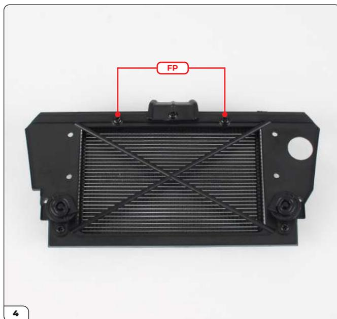
Capovolgi il telaio e fissa il radiatore con due viti FP.
