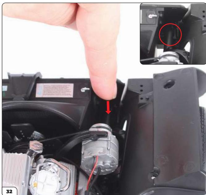
Monta il tubo d'ingresso della pompa dell'acqua calzandolo a fondo sul perno presente sul telaio ausiliario, indicato dalla freccia.
