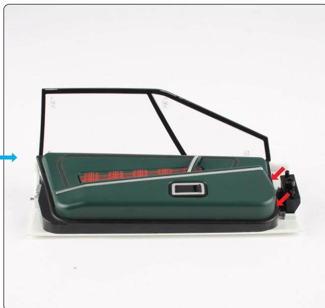
Mettez le panneau interne (étape 053) sur le cadre en insérant les languettes dans les fentes et en appuyant fermement sur l'extrémité jusqu'à qu'il s'enclenche.
