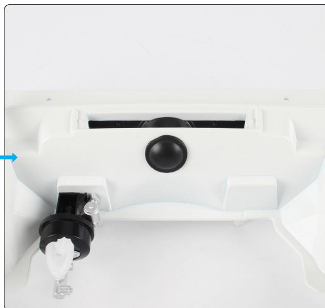
Retournez l'ensemble et prenez le capuchon de la prise d'air (57-C). Enfoncez-le dans l'emplacement rectangulaire en faisant correspondre les ergots qui n'ont pas la même longueur ni le même diamètre.
