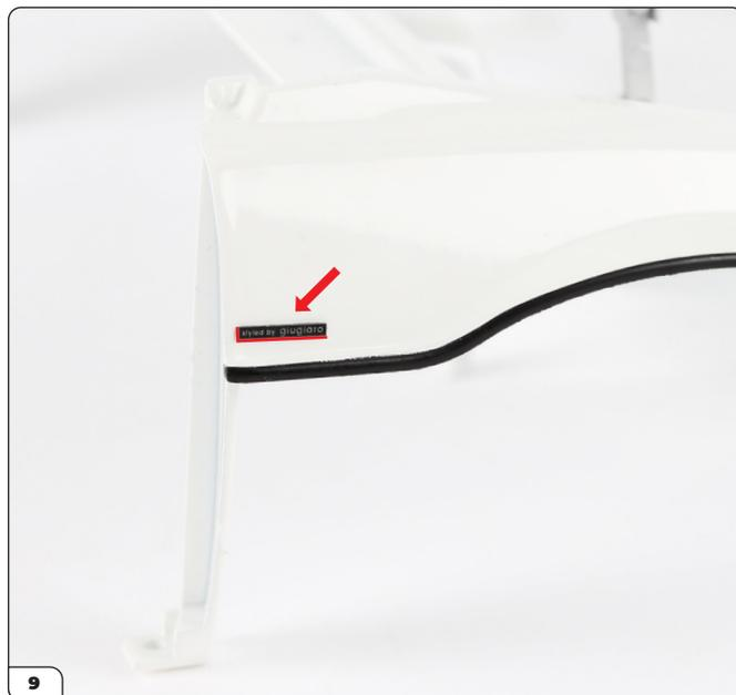
Repite para la segunda placa del guardabarros delantero en el lado derecho de la carrocería delantera.
