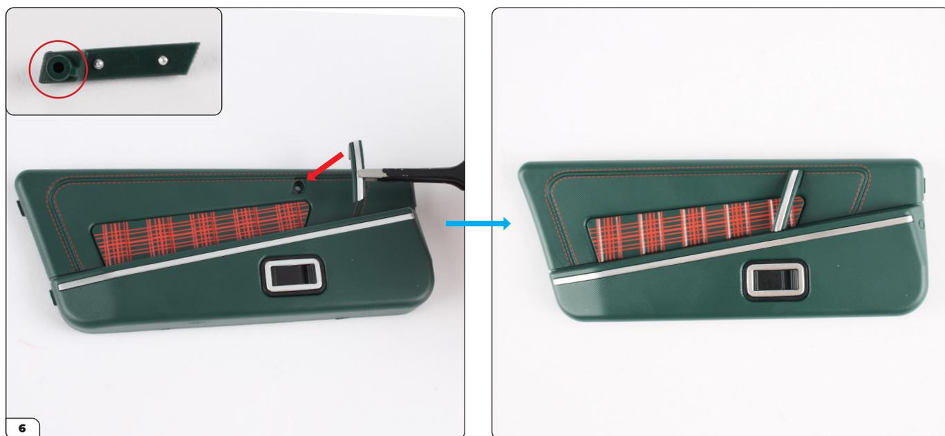
Instala la manija de agarre izquierda (53-E) utilizando el tapón con forma (encerrado en un círculo) como guía.
