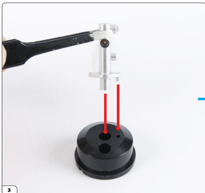
Empuja el cilindro principal de frenos en la cámara del servofreno (56-A).
