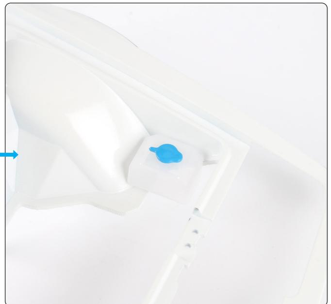
3 Posiciona el poste del tornillo en el agujero de la carrocería delantera. El depósito está diseñado para ajustarse a la curva de la carrocería.
