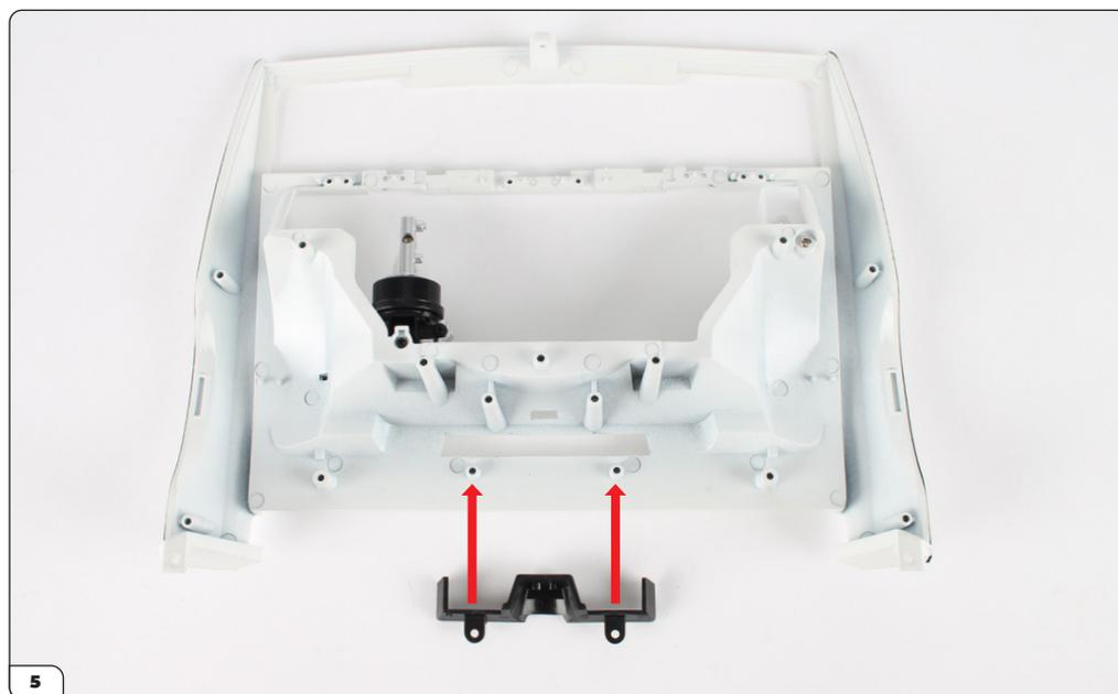
Alinea la toma de aire dual (57-A) con la carrocería delantera como se muestra.
