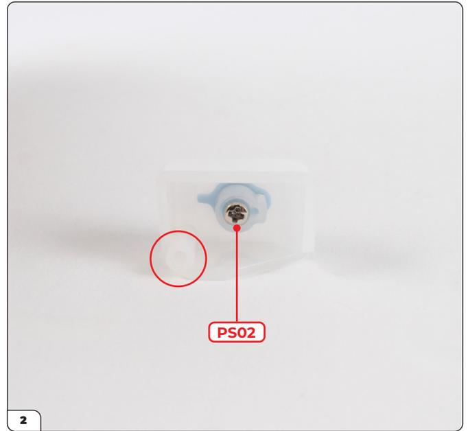
2 Fija con un tornillo PS02. Observa el poste del tornillo para el siguiente paso (encerrado en un círculo).
