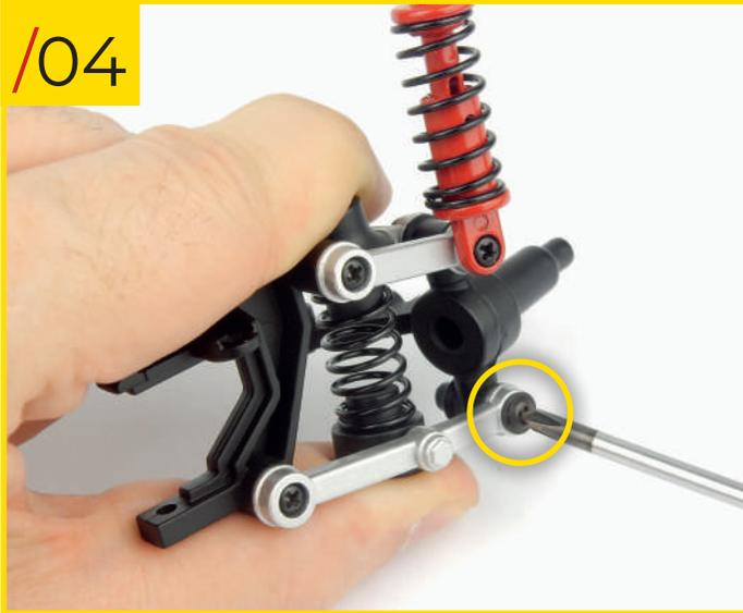
58/04 Asegure el brazo al eje portante utilizando un tornillo tipo J.
