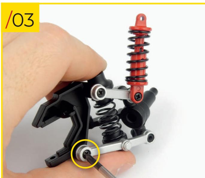
58/03 Conecte el brazo inferior B (el que no tiene un orificio central) al resto del conjunto, orientando las piezas como se muestra. Alinee el extremo más largo del brazo con el soporte y el extremo más corto con el eje portante, luego inserte el perno en el centro del brazo en uno de los orificios del soporte del resorte. Atornille un tornillo tipo B en el orificio indicado por un círculo en la foto.
