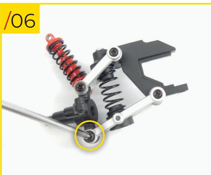
58/06 Atornille un tornillo tipo J en el orificio indicado para asegurar el brazo al eje portante.
