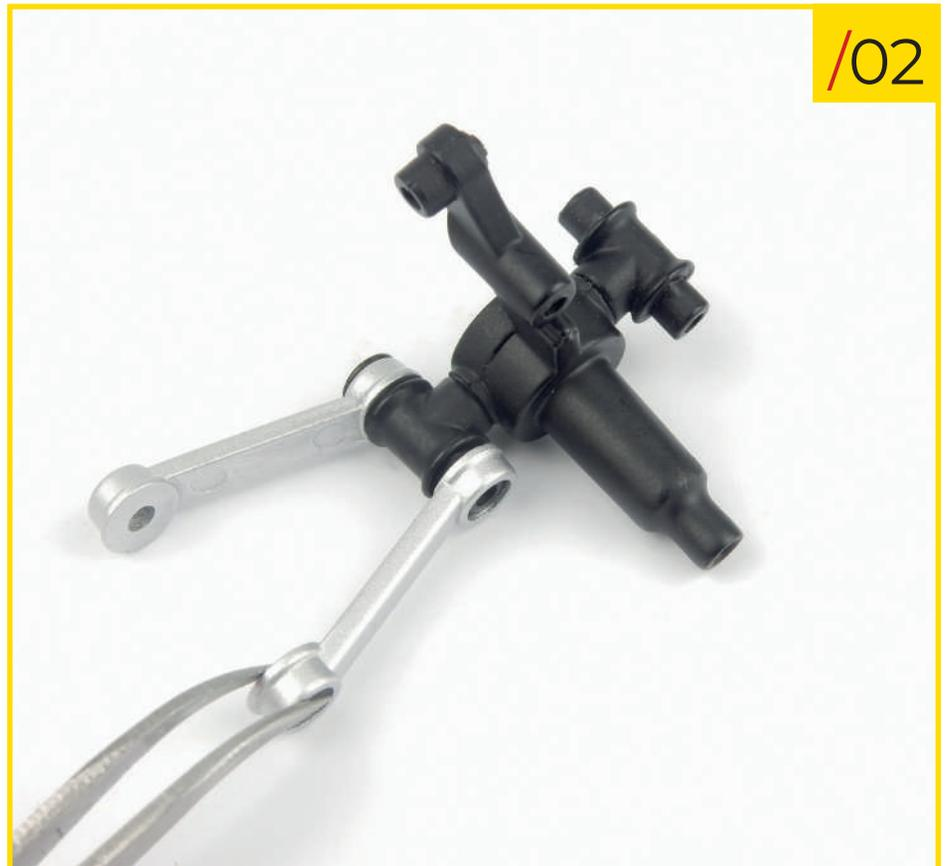
57/02 Coloque el segundo brazo superior en el eje portante, asegurándose cuidadosamente de orientar las piezas como se muestra en la foto.
