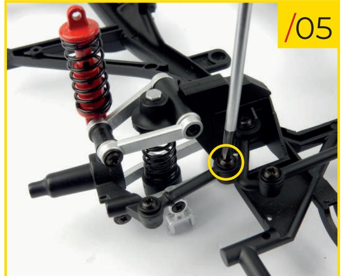
60/05 Atornille un segundo tornillo tipo J (suministrado en la etapa 59) en el orificio indicado para fijar la barra de acoplamiento al brazo loco.
