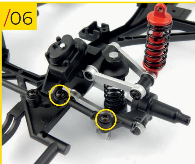
60/06 Siga el mismo proceso para el lado izquierdo: conecte el brazo y el eje portante utilizando la segunda barra de acoplamiento (etapa 59) y asegure las piezas juntas atornillando dos tornillos tipo J (etapa 59) en los orificios indicados.
