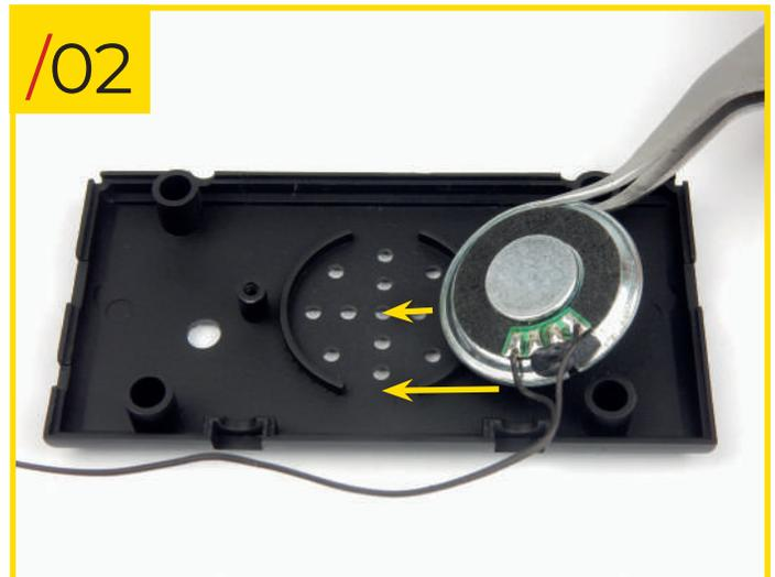
64/03 Coloque el cable del altavoz como se muestra, para asegurarse de que salga por el lateral del panel de alojamiento. Para evitar dañar el cable durante el proceso de ensamblaje, recomendamos fijarlo al panel con cinta adhesiva como se indica en la foto.
