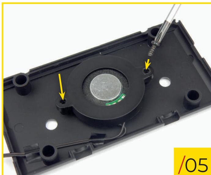
64/05 Atornille dos tornillos tipo B en los agujeros indicados para asegurar el anillo de bloqueo en su posición.
