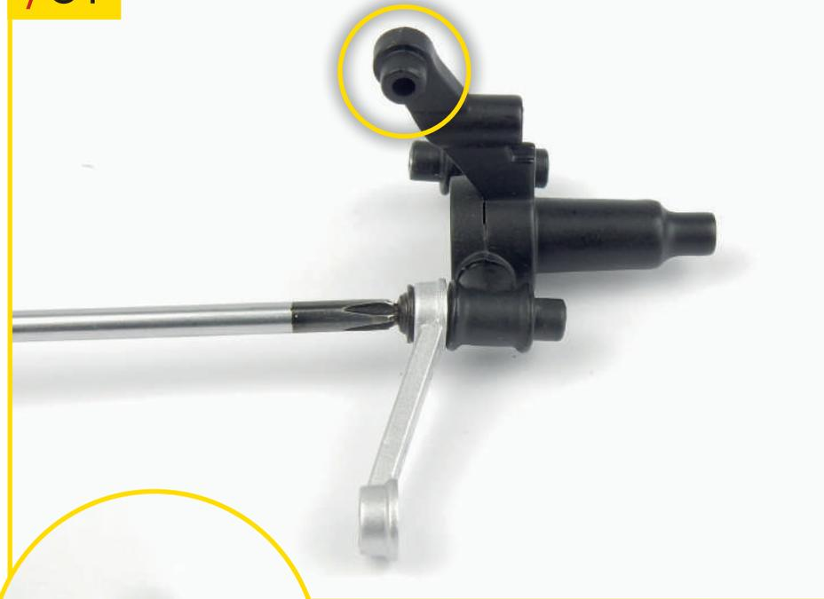
57/01 Coloque uno de los brazos superiores en el eje portante, orientando las piezas como se muestra. Use el perno resaltado por el círculo en la foto como referencia. Los orificios en los extremos de los brazos no son idénticos: para este paso, deberá usar el extremo con el orificio más grande (mostrado en la foto circular). Asegure las piezas juntas utilizando un tornillo tipo J.
