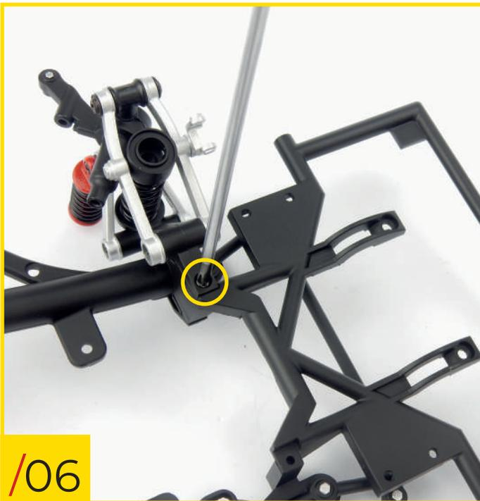
59/06 Voltee el chasis boca abajo y atornille un segundo tornillo tipo B en el orificio indicado en la parte inferior.
