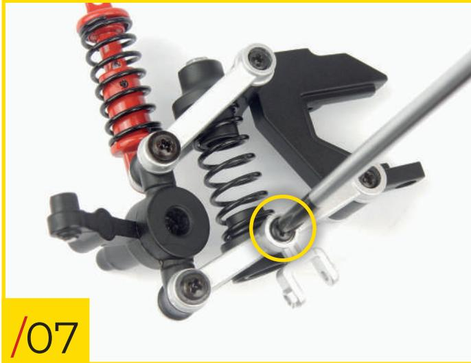
58/07 Finalmente, coloque el soporte de horquilla de manera que se alinee con el orificio central del brazo, luego asegure las piezas juntas utilizando un tornillo tipo C.
