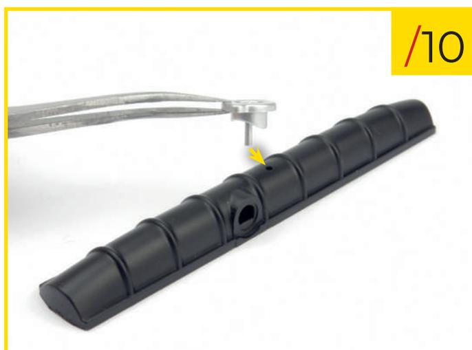
64/10 Enfoncez l'ergot du bouchon dans le trou du réservoir du radiateur comme montré.
