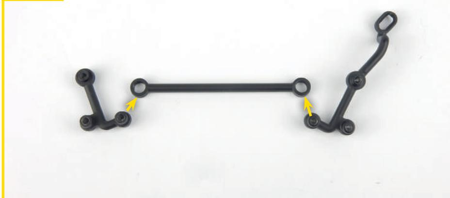
59/01 Placez la barre d'accouplement, le bras de suspension et le bras de commande sur votre plan de travail comme montré. Assemblez les pièces en insérant les ergots des bras dans les trous respectifs de la barre d'accouplement.
