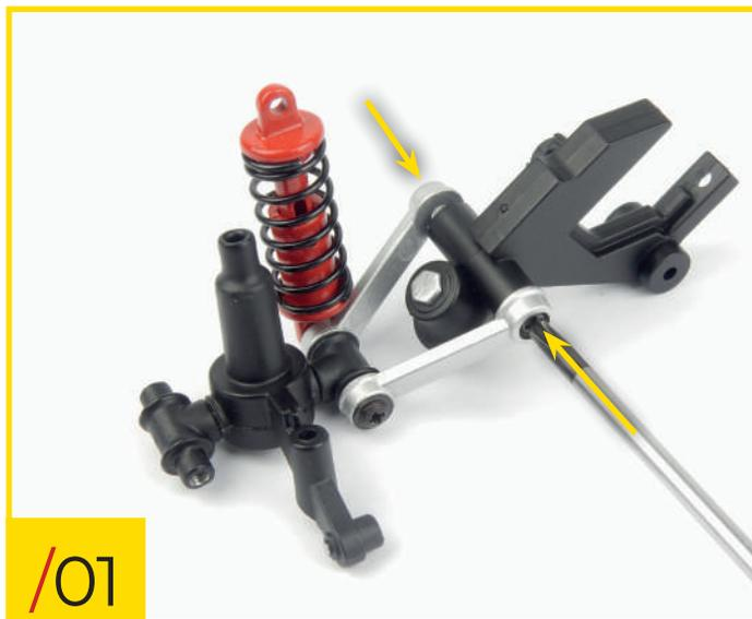
58/01 Placez l'assemblage de la suspension avant droite ainsi que la fixation avec lesquels vous avez travaillé lors de l'étape 57 sur votre surface de travail. Orientez les pièces comme indiqué et vissez-les à l'aide de deux vis de type B dans les trous indiqués.
