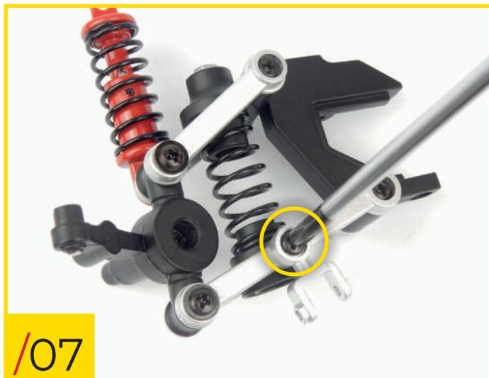
58/07 Pour finir, faites correspondre le trou de la fourche avec le trou au milieu du bras et vissez à l'aide d'une vis de type C.
