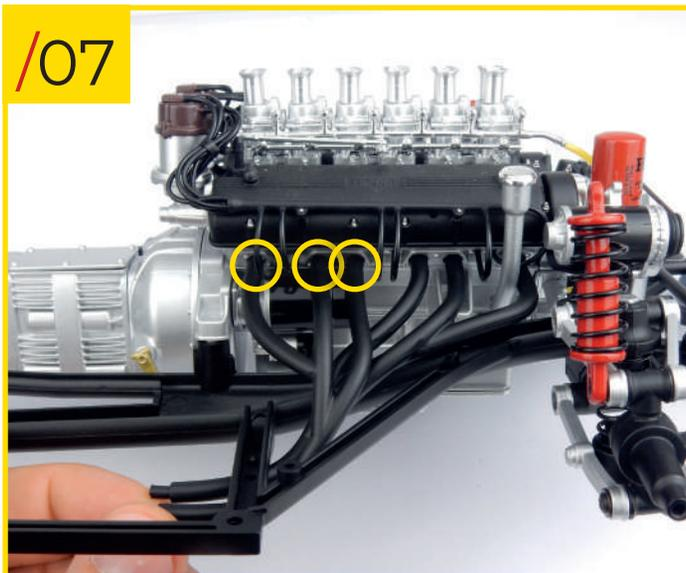
61/08 Insérez le goujon situé à l'extrémité du collecteur d'échappement arrière dans le trou correspondant sur le châssis comme indiqué.
