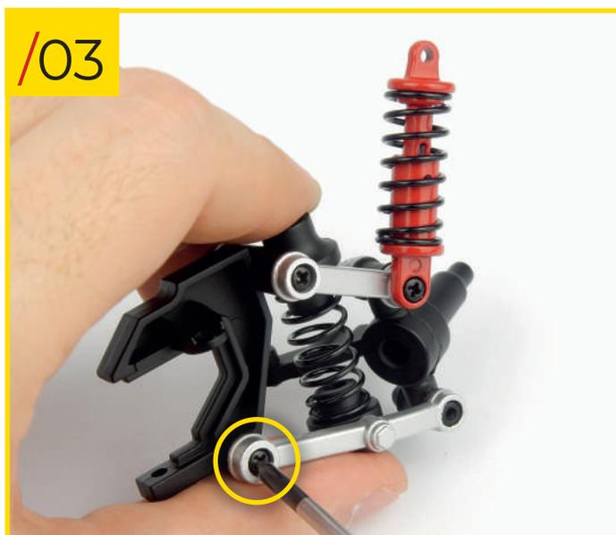
58/03 Reliez le bras inférieur B (celui sans le trou central) au reste de l'assemblage, en orientant les pièces comme indiqué. Faites correspondre le trou de l'extrémité la plus longue du bras avec le trou sur la fixation et faites correspondre le trou de l'extrémité la plus courte avec le trou sur la fusée d'essieu tout en enfonçant l'ergot situé au milieu du bras dans le trou du support de ressort. Vissez une vis de type B dans le trou qui est entouré sur la photo.
