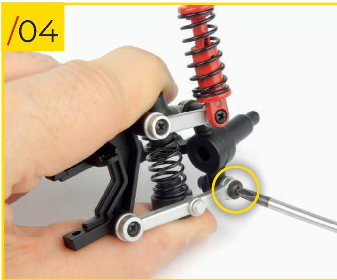
58/04 Vissez le bras sur la fusée à l'aide d'une vis de type J.
