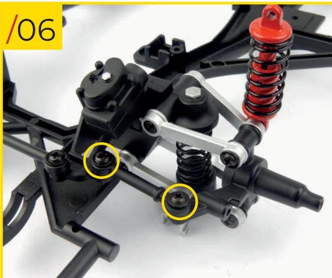
60/06 Procédez de la même manière pour le côté gauche : reliez le bras à la fusée d'essieu en utilisant la deuxième biellette (étape 59) et vissez à l'aide de deux vis de type J (étape 59) dans les trous entourés.
