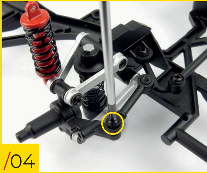
60/04 Reliez la fusée d'essieu droite au bras droit en utilisant l'une des biellettes fournies lors de l'étape 59. Placez la biellette comme montré et vissez-la sur la fusée d'essieu à l'aide d'une vis de type J (fournie lors de l'étape 59). Vous devrez comprimer la suspension pour mettre la biellette.
