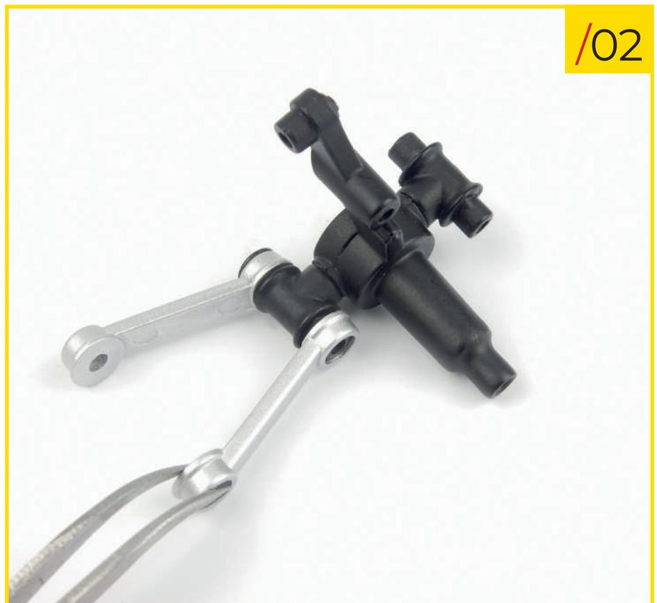
57/02 Placez le deuxième bras supérieur sur la fusée d'essieu en veillant bien à mettre les pièces dans le bon sens comme sur la photo.
