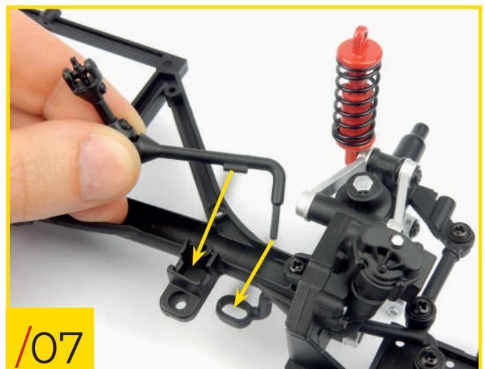
60/07 Montez la colonne de direction sur le châssis et sur le bras de commande comme montré.
