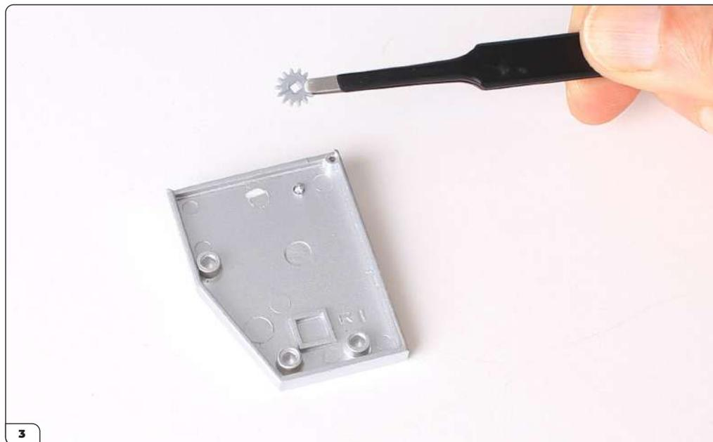
Vérifiez que l'engrenage est dans le bon sens : le côté le plus plat doit être orienté vers le haut. Poussez-le sur la cheville carrée dans le panneau intérieur de la portière.
