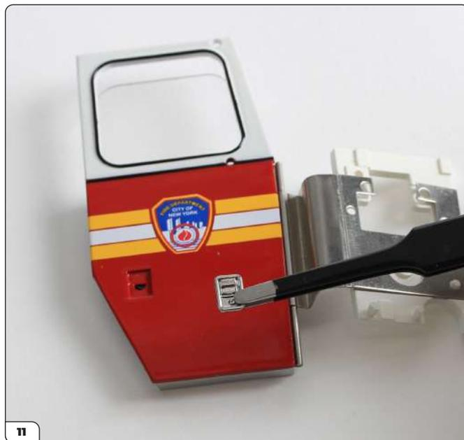
Appliquez une goutte de colle forte dans l'évidement de la poignée de portière avant d'appuyer sur cette dernière pour la mettre en position. Le raccord en forme de D facilitera le positionnement.
