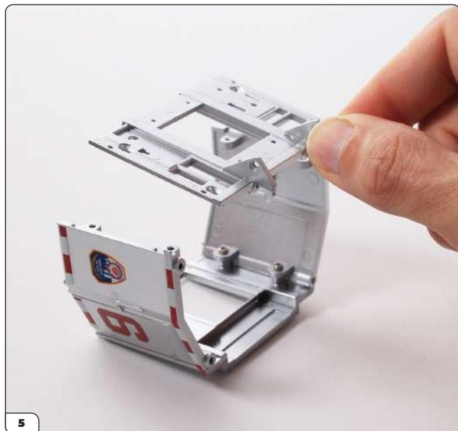
Prenez la partie arrière de la plateforme et placez les quatre trous de vis sur les quatre filetages de vis correspondants des parties latérales.
