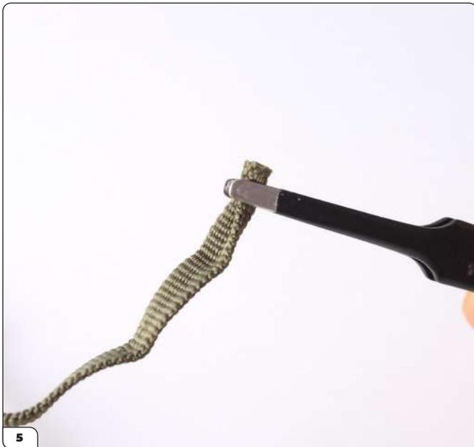
Pincez l'autre extrémité du tuyau de façon à la plier en deux dans le sens de la longueur. Cela vous permettra de l'insérer dans l'ouverture ronde du connecteur.
