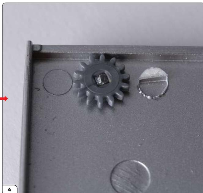
Vérifiez que l'engrenage est dans le bon sens : le côté le plus plat doit être orienté vers le haut. Poussez-le sur la cheville carrée dans le panneau intérieur de la portière.
