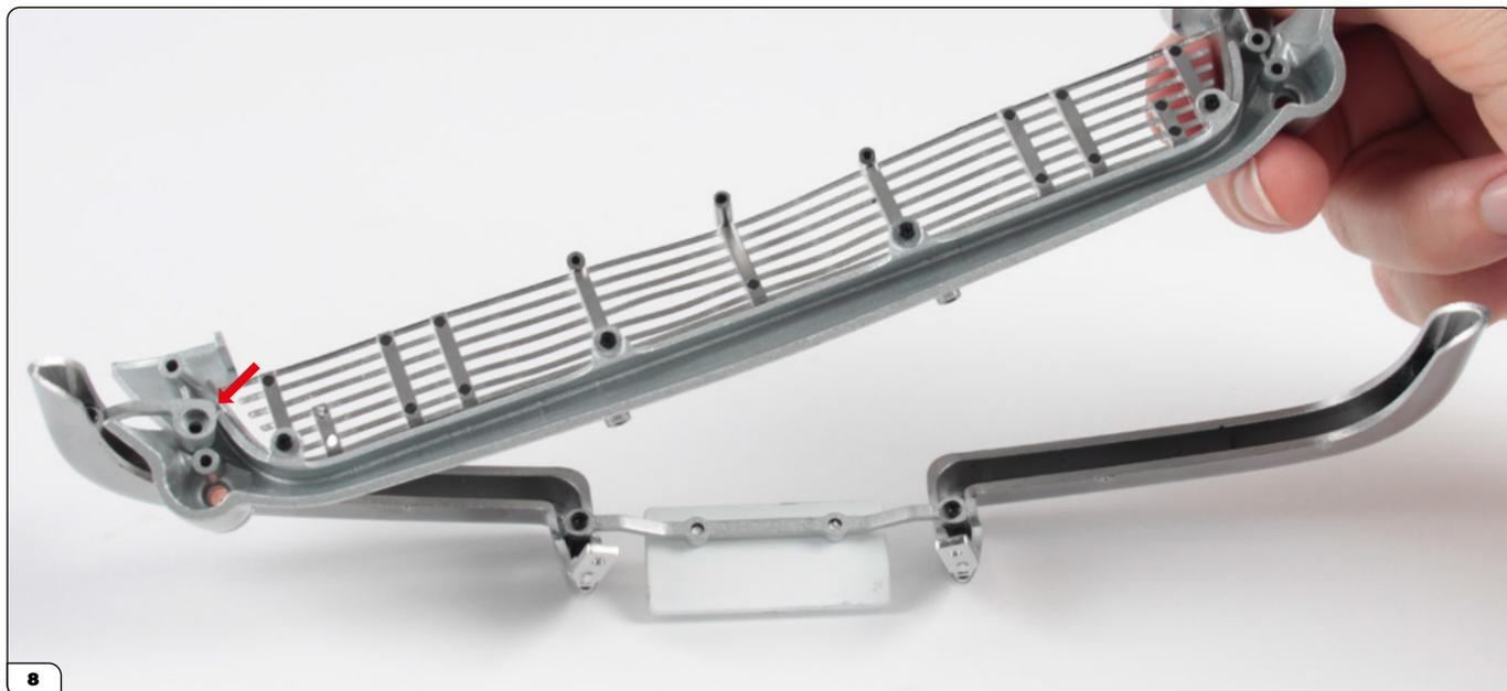
Comience a encajar el panel frontal de la carrocería en los parachoques posicionando el orificio central, resaltado en el paso anterior, debajo del soporte del parachoques (ver la flecha). Una vez en su lugar, haga descender cuidadosamente el panel frontal a su posición en los parachoques.
