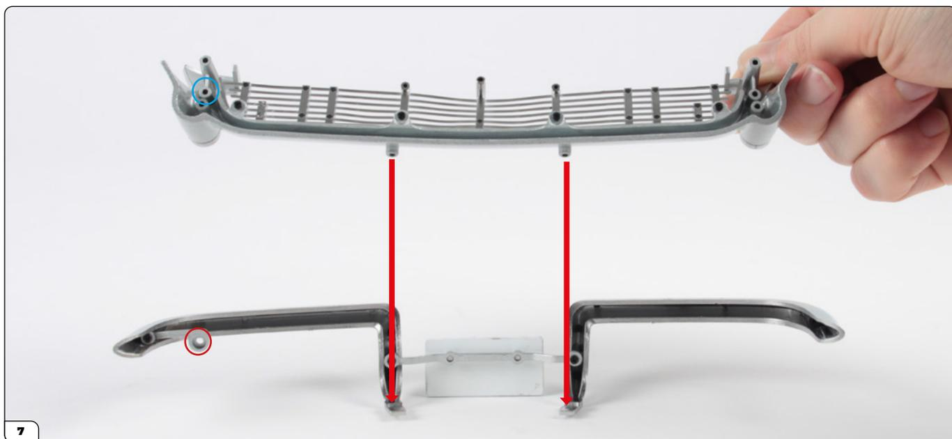
Tome el montaje del panel frontal de la carrocería realizado en la etapa 01 y alinéelo con los parachoques, como se muestra en la imagen. En la parte inferior del panel frontal hay dos orificios para tornillos en relieve que encajan en las pestañas que sobresalen de los parachoques (ver las flechas). El soporte (rodeado con un círculo rojo) encaja en el orificio central del lado izquierdo del panel frontal (rodeado con un círculo azul).
