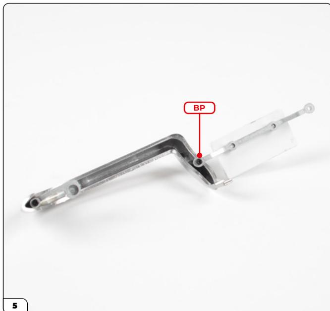
Coloque el extremo del soporte sobre el orificio para tornillos en relieve del parachoques, asegure las piezas entre sí usando un tornillo BP.
