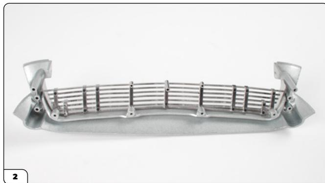
Allinea i fori in rilievo della griglia con quelli del pannello della carrozzeria.
