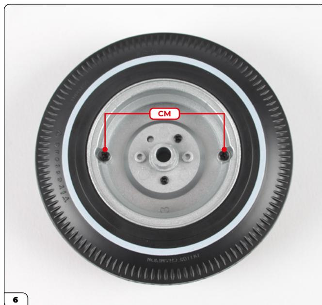
Inserisci il cerchione interno nello pneumatico e fissalo con 2 viti CM. Controlla che il bordo interno dello pneumatico sia ben inserito sotto il bordo del cerchione.
