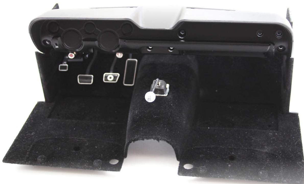
Cette image montre le tableau de bord en place sur le plancher avant. Il peut y avoir une cheville ou une vis recouverte de moquette dans le plancher avant (encart). Cela doit être supprimé avant de positionner le tableau de bord.
