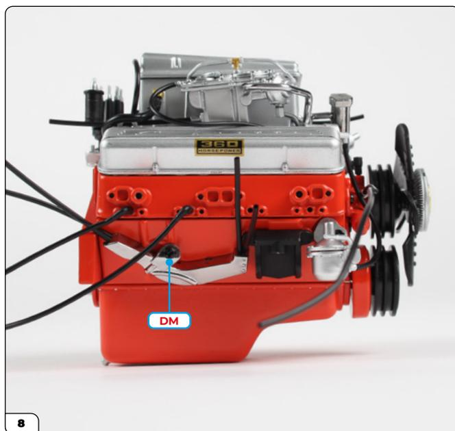
Encaje la cubierta y asegúrela usando un tornillo DM.
