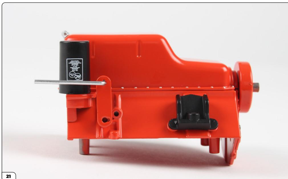
Introduzca el enganche en el orificio y luego rótelo hasta el ángulo que se muestra en la imagen.
