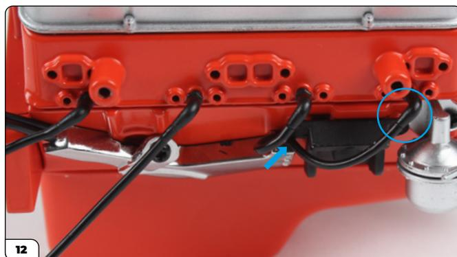
Encaje el cable de bujía interno (flecha) en la tercera bujía (rodeada con un círculo).
