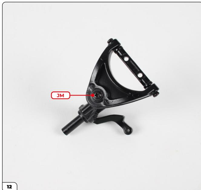
Encaje el brazo de control en el poste para tornillos y asegúrelo usando un tornillo JM.
