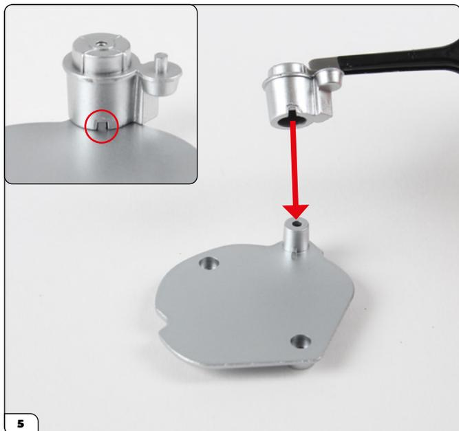
Alinee el motor de arranque (1) con la tapa de la carcasa de la campana, usando la ranura y el saliente (recuadro, rodeado de un círculo) como guía.
