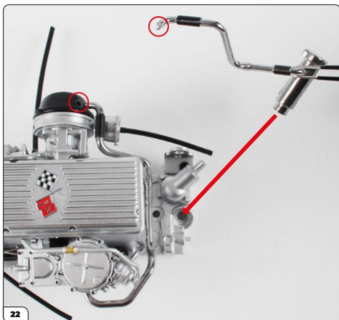
Encaje el tubo de llenado de combustible en el orificio roscado para tornillos (flecha) y luego encaje el pasador en el orificio restante del cono difusor (rodeado con un círculo).
