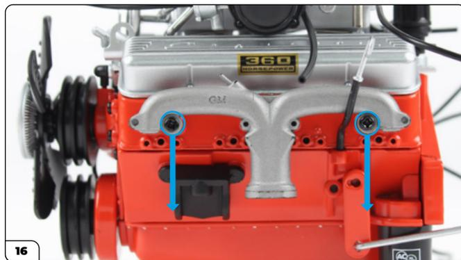
Gire el lado izquierdo del montaje hacia usted. Desatornille los dos tornillos DM que sostienen el tubo de escape (flechas) y remuévalo.
