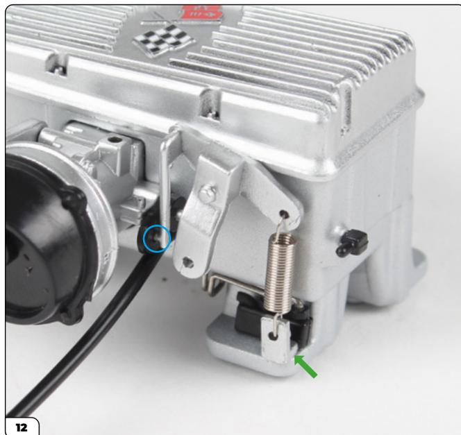
Ahora introduzca el pasador del extremo del varillaje en el orificio del soporte (círculo azul) y luego el pasador del retorno del acelerador en el orificio de la base del montaje (flecha verde).
