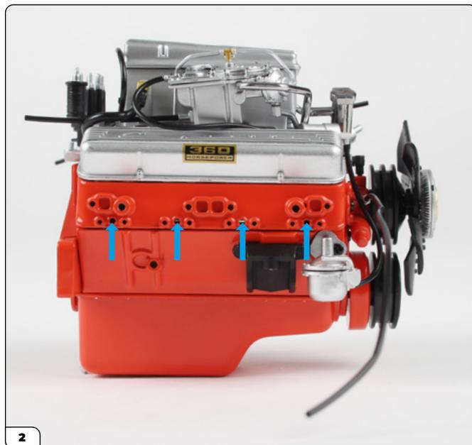
Remueva el tubo de escape derecho y téngalo aparte. Preste atención a los cuatro orificios para instalar las bujías.
