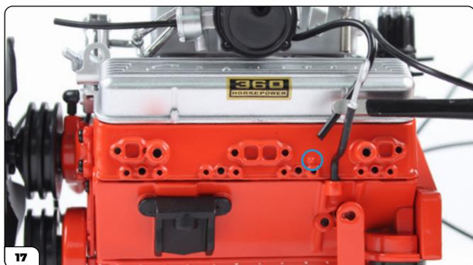
Tome el extremo de la manguera que sobresale del sistema de inyección y encájelo en el pasador pequeño (rodeado con un círculo).
