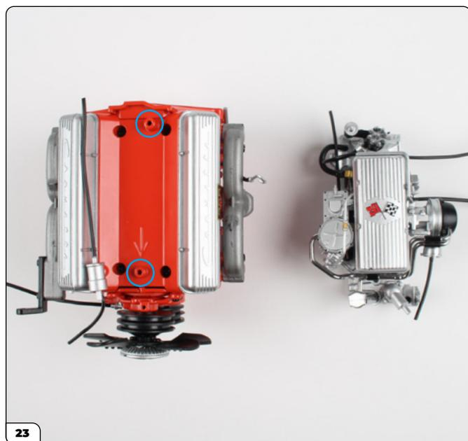
Alinee el sistema de inyección de la Etapa 11 con el montaje, como se muestra en la imagen. Localice los dos orificios en el bloque motor para encajar la unidad (rodeados con círculos).
