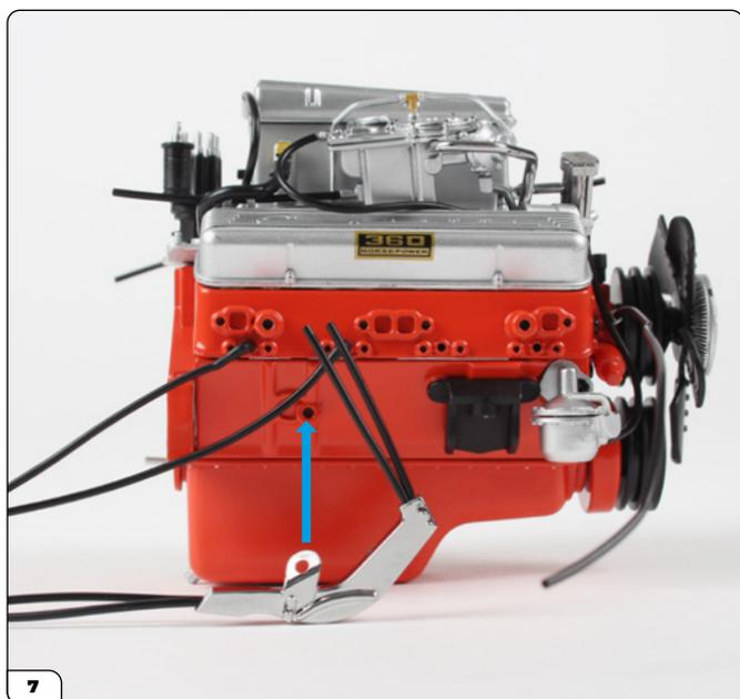
Alinee la pestaña de la cubierta de cable derecha con el montaje, tal y como se muestra en la imagen (flecha).
