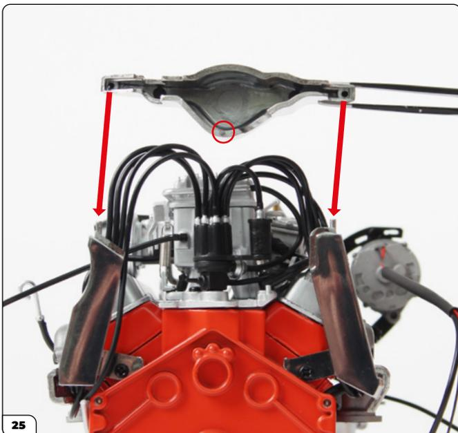
Alinee la cubierta de cables superior con el montaje, como se muestra en la imagen (flechas). La cubierta de cables superior tiene un pasador (rodeado con un círculo) que encaja en el poste resaltado en el paso 19.
