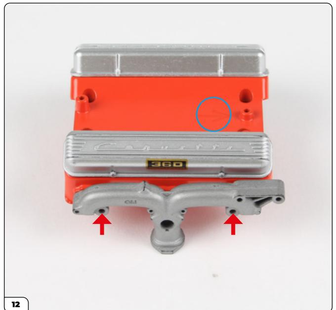
Gire el montaje (con la flecha apuntando a la derecha, rodeada de un círculo) y encaje el tubo de escape derecho de la misma manera que lo hizo con el anterior (flecha).
