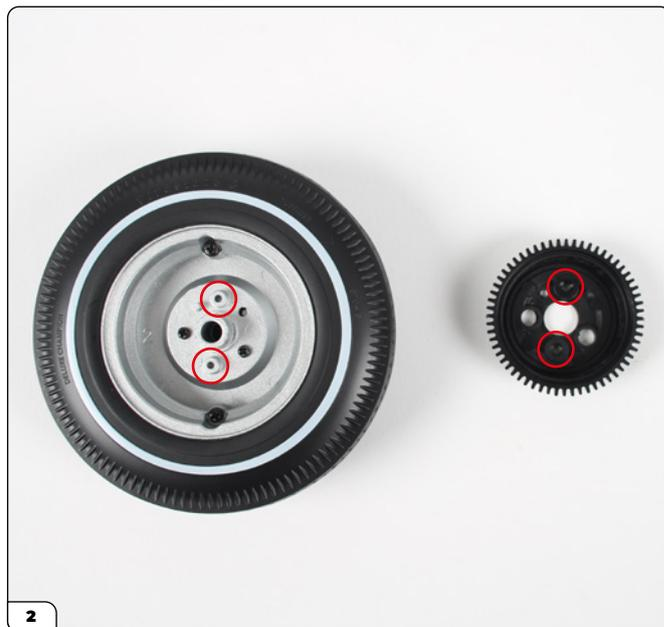
Alinee las piezas como se muestra en la imagen. Los orificios para tornillos en el tambor encajan en los orificios para tornillos de la llanta (rodeados con círculos).
