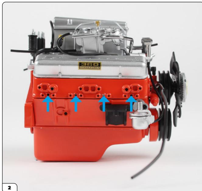
Rimuovi il collettore di scarico di destra e conservalo. Presta attenzione ai quattro fori per l'installazione delle candele.
