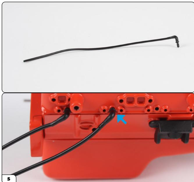
Inserisci una candela nel cavo lungo 100 mm e poi spingila nel foro in sequenza indicato dalla freccia.
