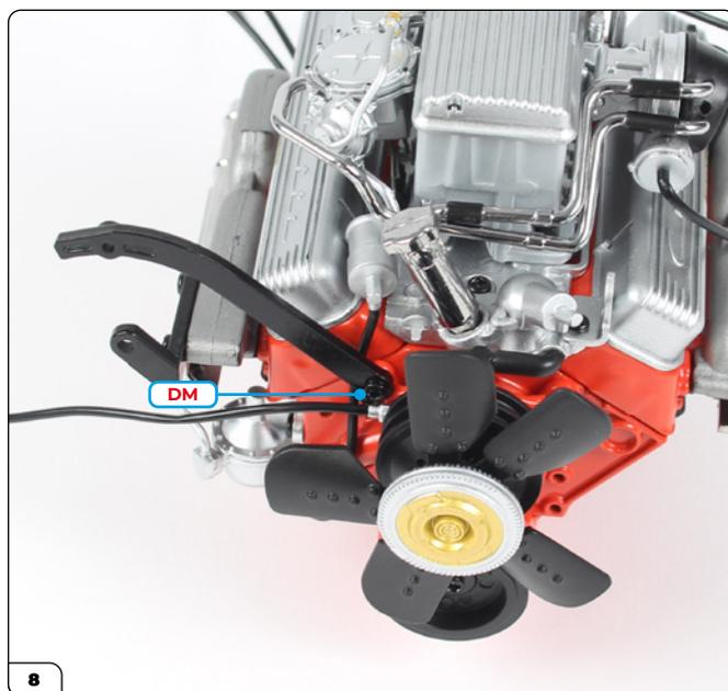
Posiziona la staffa sul foro e fissala con una vite DM: non serrare completamente la vite perché la staffa deve potersi muovere.
