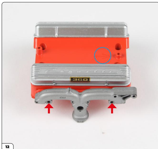
Ruota il gruppo (freccia rivolta a destra, cerchiata) e monta il collettore di scarico destro nello stesso modo (freccie).
