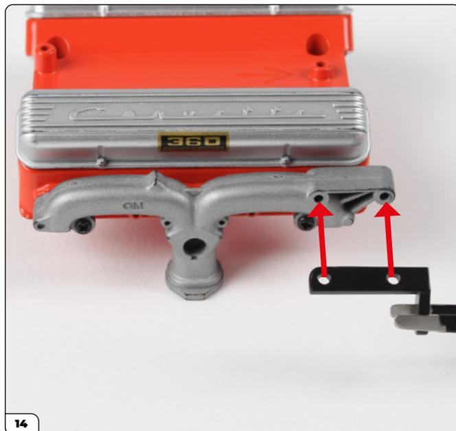
Unisci la staffa inferiore con il collettore di scarico di destra (freccie).
