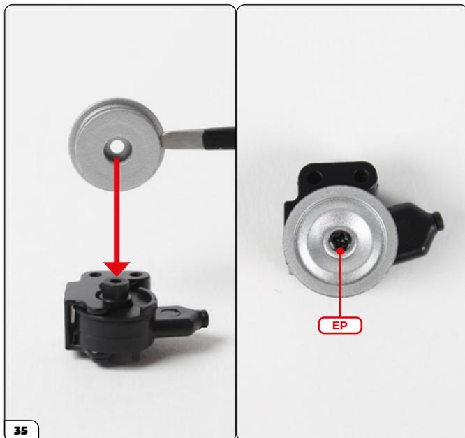
35 Infilare la puleggia nel foro della vite in rilievo (freccia) e fissala con una vite EP.
