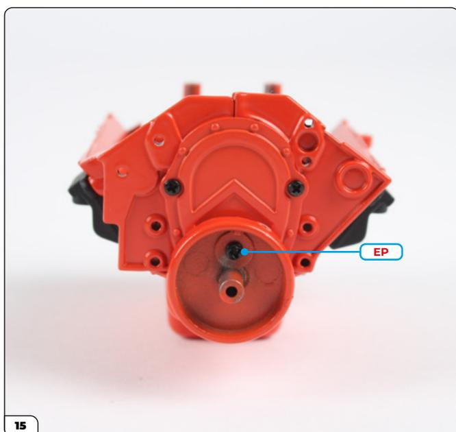
Tieni ferma la puleggia e fissala con una vite EP. Se necessario, lubrifica la vite con dell'olio.
