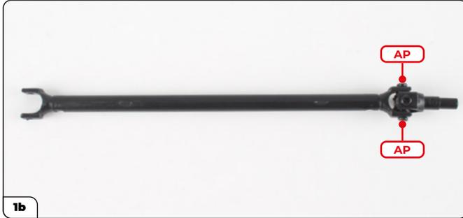
Encaje la articulación universal en el conector del árbol de transmisión y asegure las piezas entre sí usando dos tornillos AP (imagen 1a), luego introduzca la articulación en el extremo del árbol de transmisión y asegúrela con 2 tornillos AP (imagen 1b).
