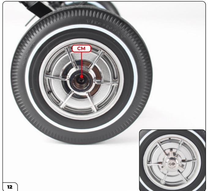
Asegure la rueda usando un tornillo CM. Vuelva a introducir el tapón en el tapacubos (recuadro).
