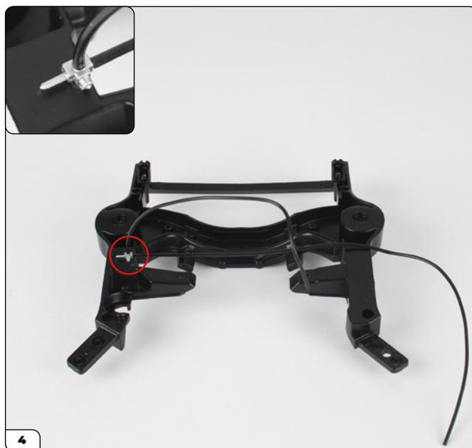
Introduzca la derivación en el orificio del chasis delantero (rodeado con un círculo).
