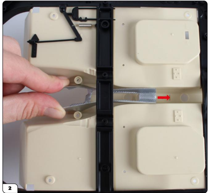
Para encajar el escudo térmico, apriete cuidadosamente el extremo ancho e introdúzcalo por debajo del travesaño, pasando entre las columnas para tornillos, como se muestra en la imagen.
