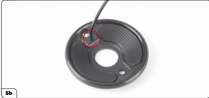
Retire el latiguillo de freno más largo de la derivación (imagen 5a, flecha), luego introdúzcalo en el pasador de la cubierta del tambor de freno (imagen 5b, rodeado con un círculo).
