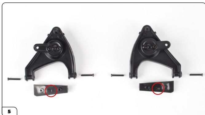
Alinee los ejes (marcados "L" y "R", rodeadas con un círculo) con los brazos de control, como se muestra en la imagen. Luego, prepare 4 tornillos KM que servirán para asegurar los ejes desde la parte externa de los brazos.
