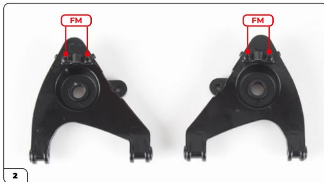
Coloque los soportes en los brazos de control, como se muestra en la imagen, y asegúrelos en su lugar usando 4 tornillos FM.
