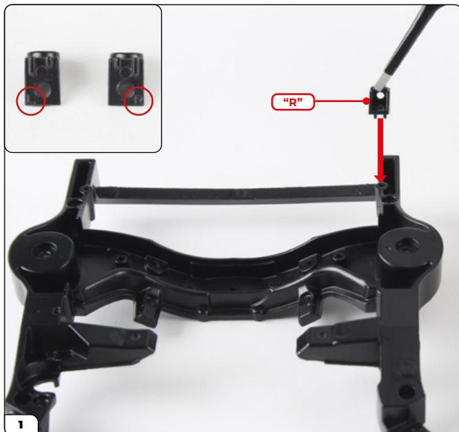
Los dos soportes están marcados con una "L" y una "R" para distinguir el izquierdo (L) del derecho (R) (recuadro, rodeadas con un círculo). Encaje el soporte derecho (R) en el chasis delantero (flecha).
