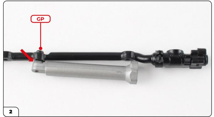
Posicione el cilindro en la barra central de dirección, como se muestra en la imagen (asegúrese de que el lado redondeado del cilindro esté en contacto con la barra, flecha). Luego asegure las piezas entre sí usando un tornillo GP.
