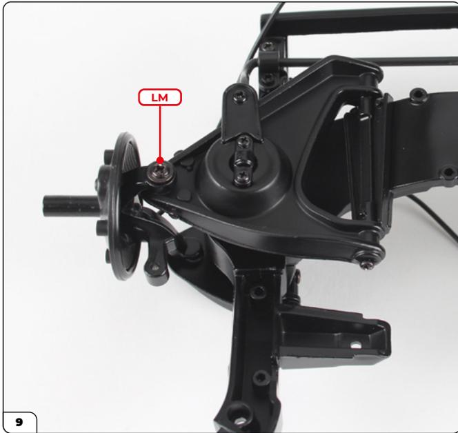
Dé la vuelta al montaje y asegure el brazo de control inferior usando un tornillo LM.
