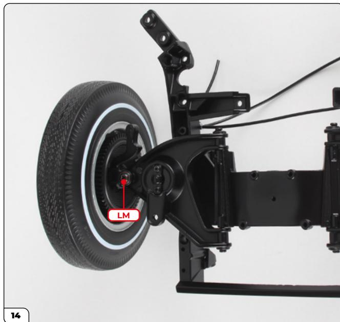
Encaje la abertura en el poste y asegure la pieza usando un tornillo LM.
