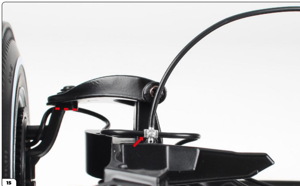
Tome el extremo suelto de la manguera de freno de la rueda izquierda, páselo por detrás del montante (línea discontinua) y continúe a pasarla hasta conectarla con la derivación (flecha), como se muestra en la figura.
