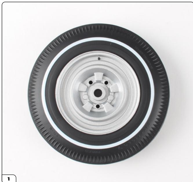
Introduzca la llanta exterior en el neumático hasta que las partes queden enrasadas.
