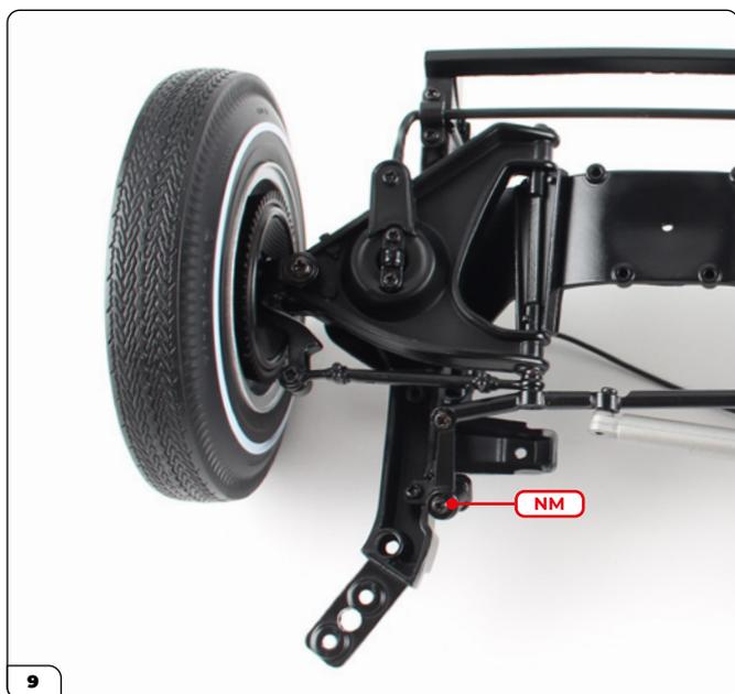
Asegure el extremo del brazo auxiliar al soporte con un tornillo NM.
