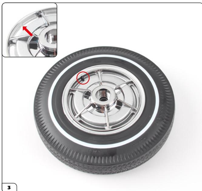
Dé nuevamente la vuelta al montaje y encaje el tapacubos de seis radios en su lugar, alineando la ranura del tapacubos (recuadro, flecha) con la válvula de aire (rodeada con un círculo).
