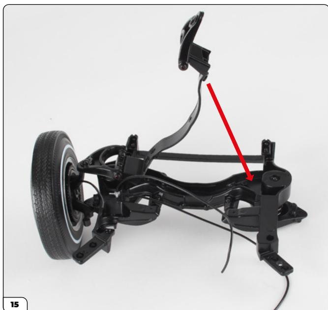
Gire cuidadosamente el montaje y, luego, baje la cubierta delantera del chasis, tal y como indica la flecha.
