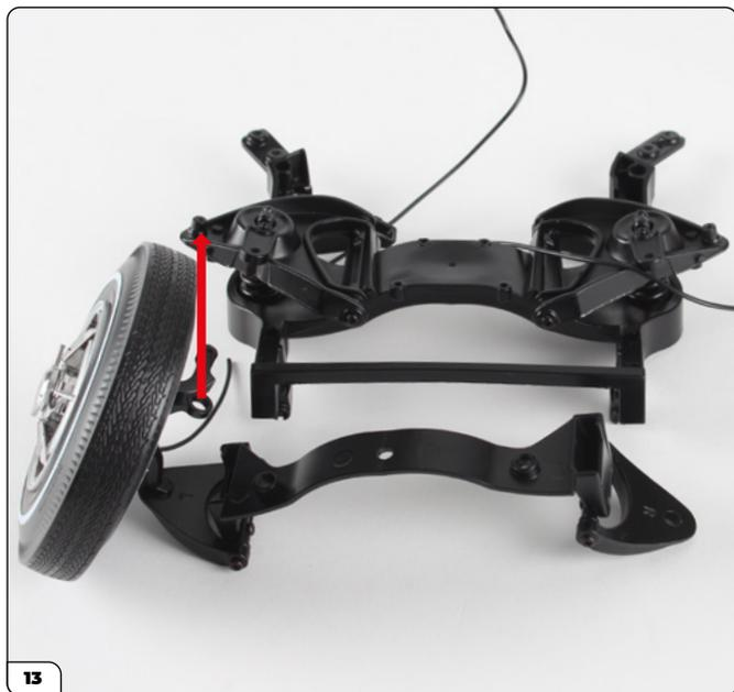
Alinee el montaje del paso anterior con el chasis delantero. El montante de suspensión izquierdo tiene una abertura que encaja en el poste para tornillos elevado del brazo de control inferior izquierdo (flechas).
