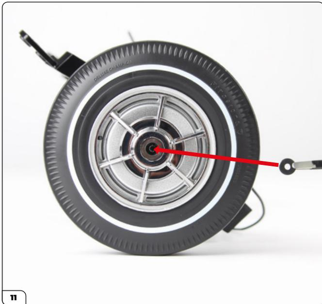
Retire el tapón del tapacubos y después posicione la rueda en el montante, tal y como se muestra en la imagen. Compruebe que la parte externa de la rueda esté orientada en dirección contraria al montante. Coloque la arandela dentro el tapacubos (flecha).
