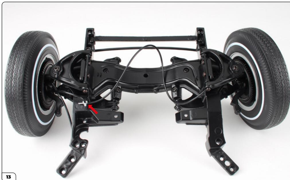
Vuelva a encajar el extremo suelto del latiguillo de freno más largo en la derivación (flecha).
