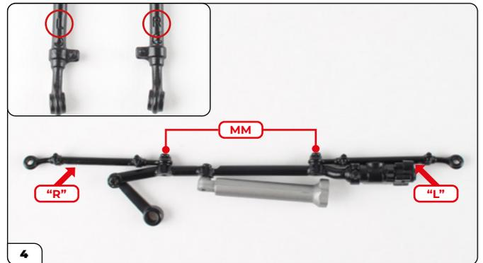
Encaje las varillas de dirección (marcadas con una "L" (izquierda) y con una "R" (derecha), recuadro, rodeadas con un círculo) y asegúrelas a la barra central de dirección usando 2 tornillos MM. Tenga en cuenta que las incisiones "L" y "R" deben ser ubicadas en las posiciones indicadas por las flechas.
