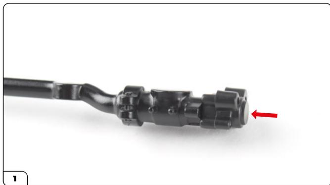
Inserisci il servosterzo nell'estremità della barra dello sterzo, come illustrato.
