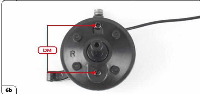
Monta il parapolvere sul fusello destro come mostrato (6a) e fissalo con due viti DM (6b).
