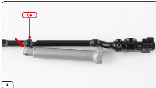
Posiziona l'ammortizzatore dello sterzo sulla barra dello sterzo (nota che il lato arrotondato dell'ammortizzatore è a contatto con la barra, come indicato dalla freccia) e fissalo con una vite GP.
