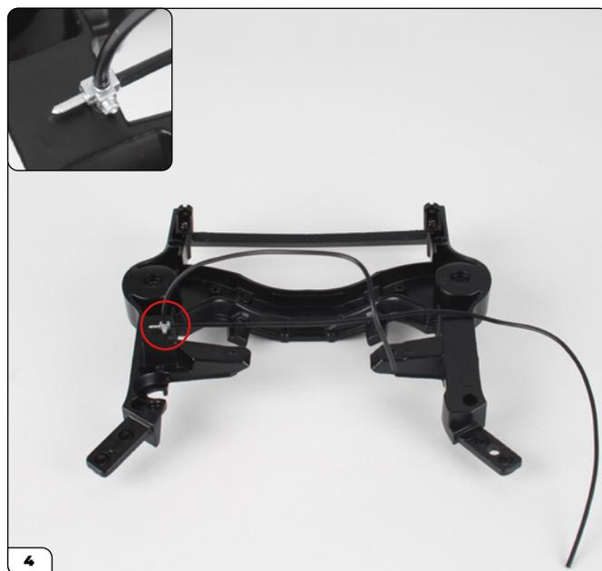
Spingi il raccordo nel foro sul telaio anteriore (cerchiato).
