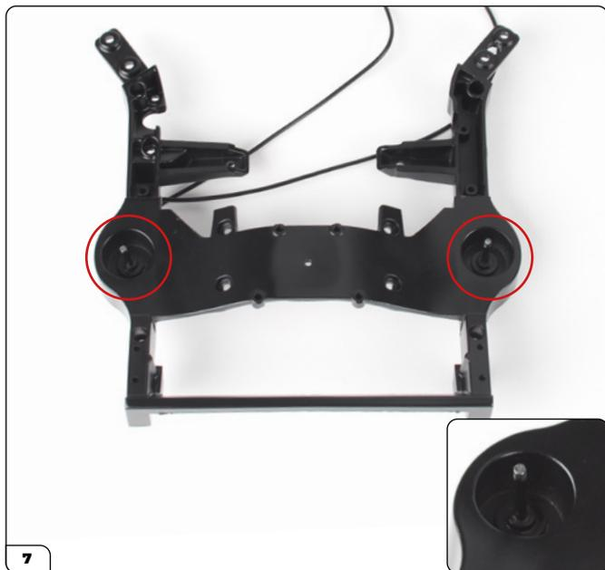
Inserisci gli steli dei cilindri nei fori a forma di D all'interno degli incavi del telaio anteriore (cerchiati), come mostrato.
