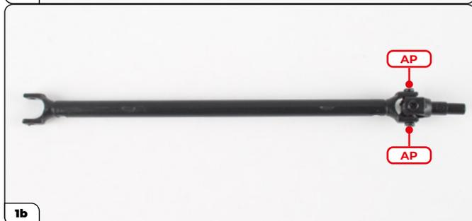
Inserisci il giunto universale nel raccordo dell'albero di trasmissione e fissalo con due viti AP (1a), quindi spingi il giunto nell'estremità dell'albero di trasmissione e fissalo con due viti AP (1b).
