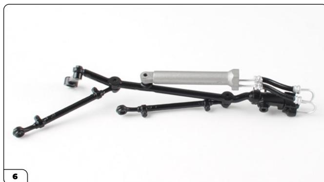
Una volta assemblata, la barra dello sterzo dovrebbe avere questo aspetto.
