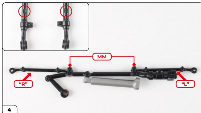
Monta i tiranti dello sterzo (contrassegnati con "L" e "R", all'interno, cerchiati) e fissali alla barra dello sterzo con due viti MM. Fai attenzione a posizionare le lettere "L" e "R" come indicato dalle frecce nell'immagine.
