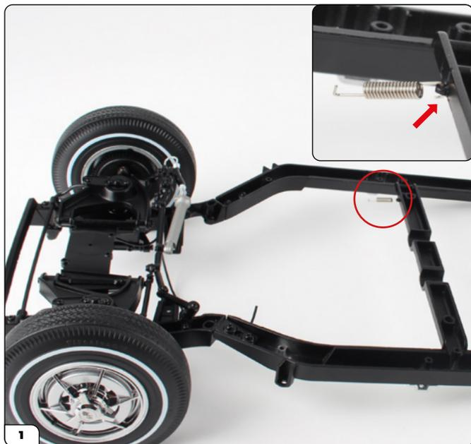
Inserisci l'estremità a U della molla del cavo del freno a mano (in figura, freccia) nell'occhiello collocato sul telaio (cerchiato).
