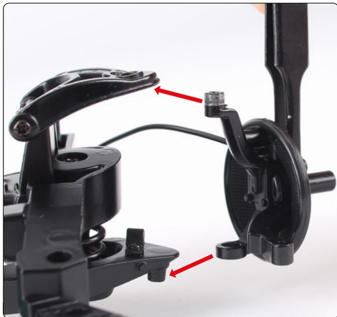
Unisci il fusello al telaio come illustrato. Inserisci le viti nei punti di fissaggio (freccie).
