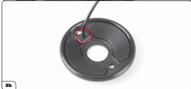
Rimuovi il tubo del freno più lungo dal raccordo (5a, freccia) e inseriscilo nel perno del parapolvere (5b, cerchiato).
