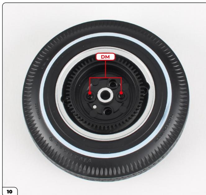
10 Inserisci il tamburo del freno nella ruota anteriore destra dalla fase 18 e fissalo con due viti DM.
