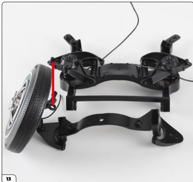
Allinea il gruppo al telaio anteriore. Il fusello di sinistra è dotato di un occhiello: uniscilo alla sede rialzata per le viti collocata sul braccetto inferiore sinistro (freccia).
