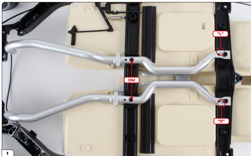
I tubi di scarico sono contrassegnati da "L" e "R" come indicato. Montali sul telaio come illustrato e fissali con due viti DM.
