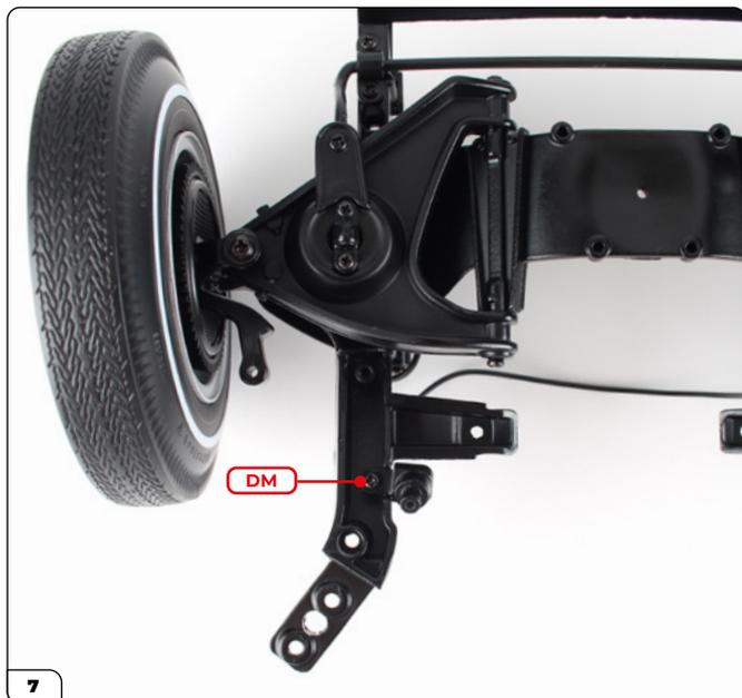
Monta la staffa del tirante sull'incavo del telaio anteriore e fissala con una vite DM.
