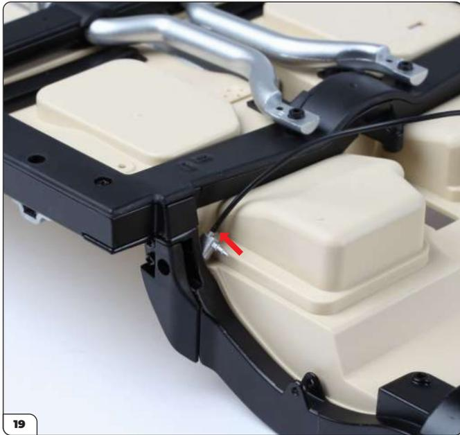
Conecte un extremo de latiguillo de freno largo (130 mm) en el pasador del conector plateado del lado derecho (flecha).
