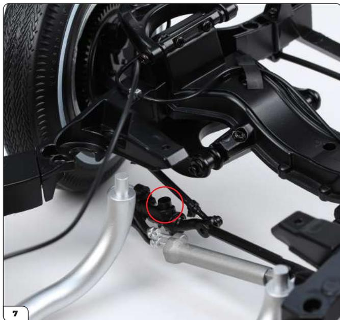
El orificio redondo del enlace encaja en el poste de la barra central de dirección (rodeado con un círculo).
