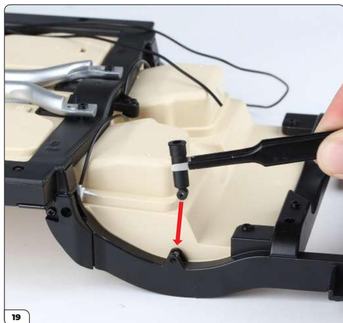
Encaje el cilindro de amortiguación trasero en el chasis trasero, como se muestra en la imagen (flecha).
