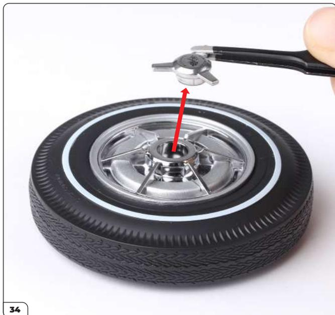
De ser necesario, retire el tapón del tapacubos de las ruedas ensambladas en las etapas 25 y 27.
