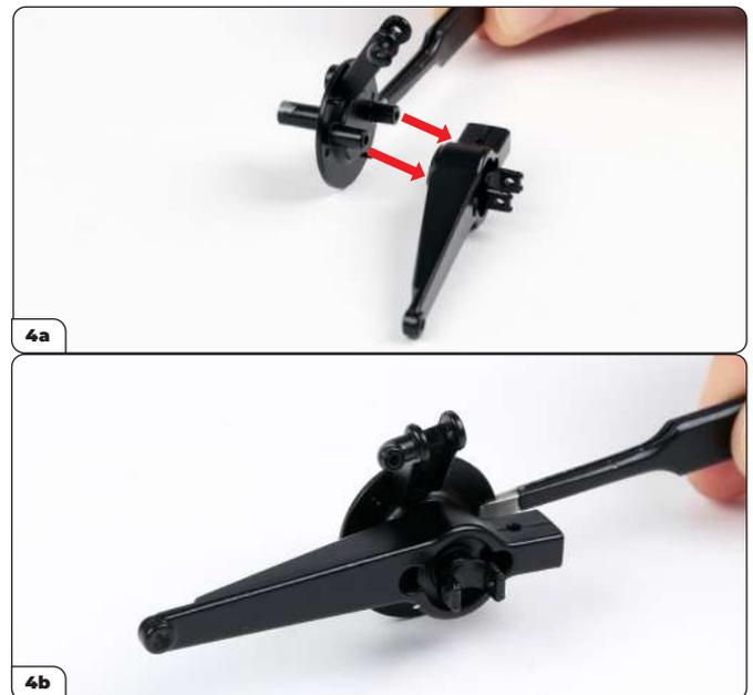
Alinee la mangueta izquierda con el brazo de control superior, como se muestra en la imagen 4a. A continuación, introduzca los postes para tornillos de la mangueta en los orificios para tornillos del brazo de control (imagen 4b).
