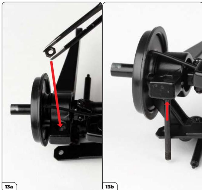
Dé vuelta al montaje y coloque una tuerca hexagonal en el brazo de control superior izquierdo (imagen 13a, flecha). Desde abajo (imagen 13b, flecha), enrosque el extremo acanalado más largo de la varilla de retención en la tuerca que acaba de colocar en el brazo de control, hasta que la punta de la varilla quede a ras con la tuerca.
