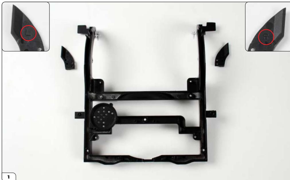
Alinee los paneles laterales del chasis (marcados con una 'L' (izquierdo) y con una 'R' (derecho), rodeadas con un círculo) con el chasis trasero, como se muestra en la imagen.
