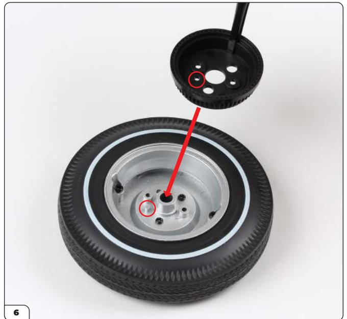
Encaje el tambor de freno trasero derecho en la llanta externa, usando el pasador de bloqueo y el orificio como guía para alinear las partes correctamente.
