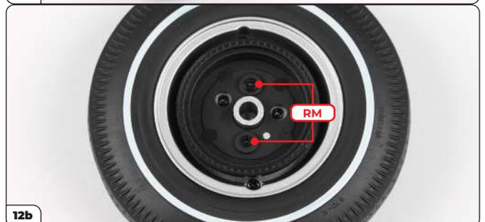
Tome la rueda montada en la Etapa 25. Encaje el tambor de freno trasero izquierdo en la llanta externa (imagen 12a, flecha). Use el pasador de bloqueo y el orificio como guía para alinear las partes correctamente (imagen 12a, rodeados con un círculo). Asegure las piezas entre sí usando 2 tornillos RM (imagen 12b).
