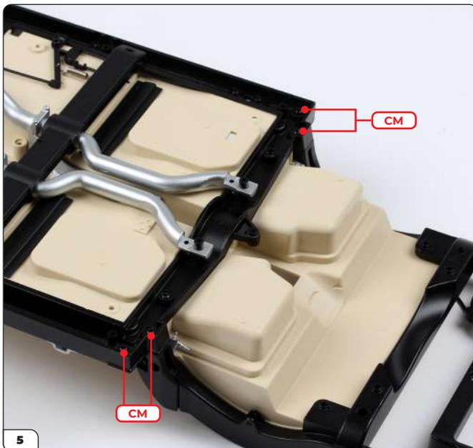
Asegure el chasis trasero usando 4 tornillos CM.
