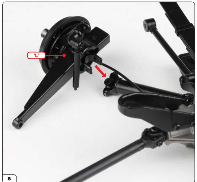
Alinee la mangueta izquierda con el eje de propulsión del lado izquierdo del diferencial, como se muestra en la imagen (flecha).
