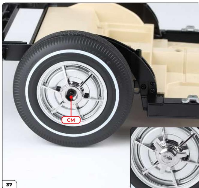
Siguiendo los mismos pasos, encaje la rueda trasera derecha en la otra mangueta, colocando una arandela fina en el extremo del poste y asegurando la rueda con un tornillo CM. Luego, encaje el tapón del tapacubos en su lugar (recuadro).
