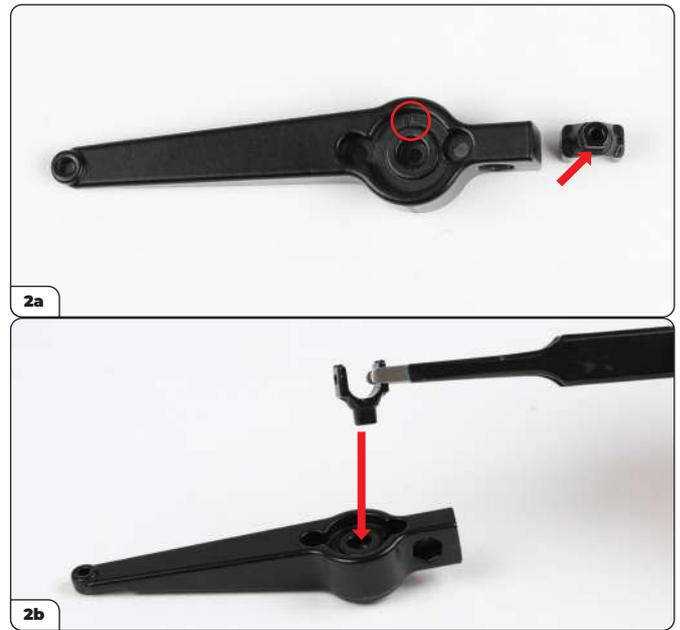
Tome el brazo de control superior izquierdo (imagen 2a, marcado con una 'L', rodeada con un círculo) y el conector del eje de transmisión (imagen 2b, flecha). Encaje el conector en el brazo de control (imagen 2b).
