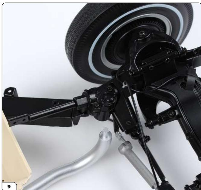
Coloque el montaje de la caja de cambios en el área ahuecada del chasis, como se muestra en la imagen.
