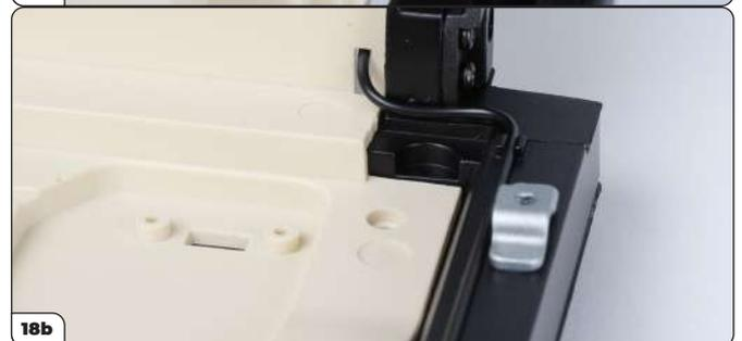
Introduzca el extremo del latiguillo en el pasador del conector plateado (imagen 18a, flecha). A continuación, ajuste el cable hasta que quede plano a lo largo del chasis, como se muestra en la imagen 18b.
