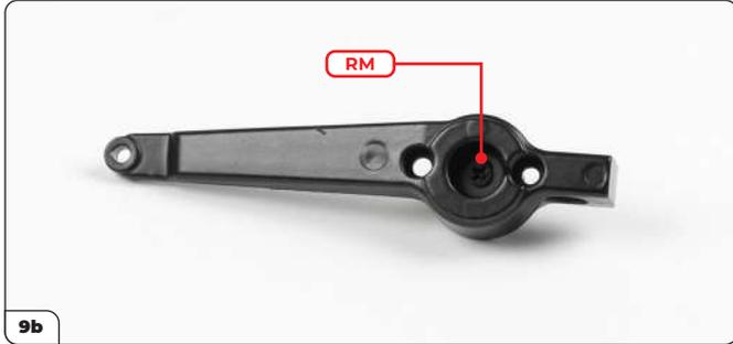
Encaje el otro conector del eje de transmisión en el brazo de control superior derecho, marcado con una 'R' (imagen 9a). Asegúrelos entre sí usando un tornillo RM (imagen 9b).
