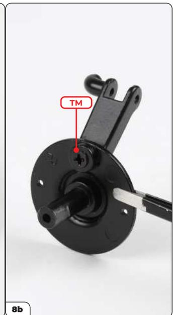
Encaje el brazo de control inferior derecho en la mangueta trasera derecha, ambas piezas están marcadas con una 'R' (imagen 8a, rodeada con un círculo). Asegure las piezas entre sí con un tornillo TM (imagen 8b).
