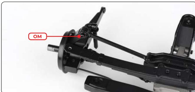
Encaje los extremos grandes de las barras oscilantes inferiores en los brazos de control inferiores y asegure cada uno de ellos con un tornillo OM.
