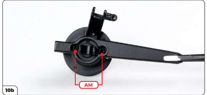
Encaje la mangueta derecha en el brazo de control superior derecho (imagen 10a), luego asegure las piezas entre sí usando 2 tornillos AM (imagen 10b).
