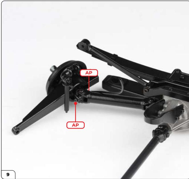
Encaje la mangueta en el eje y asegúrela con 2 tornillos AP.
