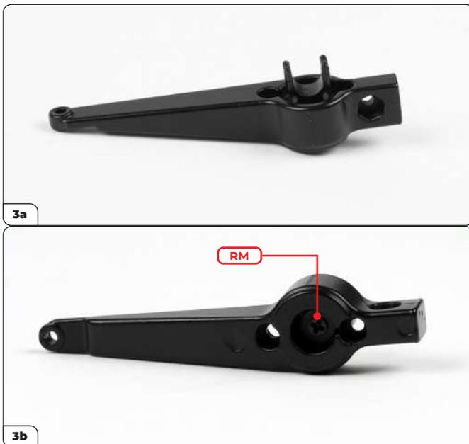
Mientras sujeta el conector para mantenerlo en su sitio, dé la vuelta al montaje y asegúrelos usando un tornillo RM (imagen 3b).
