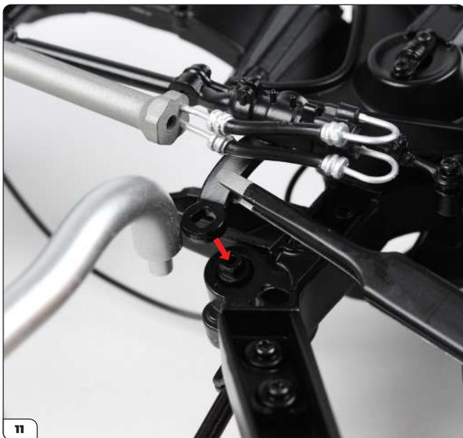
Encaje el orificio cuadrado del enlace en la caja de cambios (flecha).
