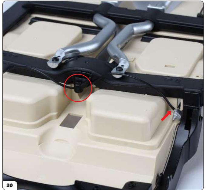
Pase el cable por debajo del saliente de bastidor del chasis (rodeado con un círculo) y conecte el otro extremo en el pasador del lado izquierdo del conector (flecha).
