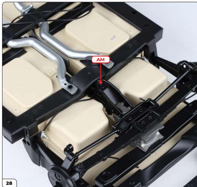
Para asegurar el montaje, comience introduciendo un tornillo AM a través del soporte angular.
