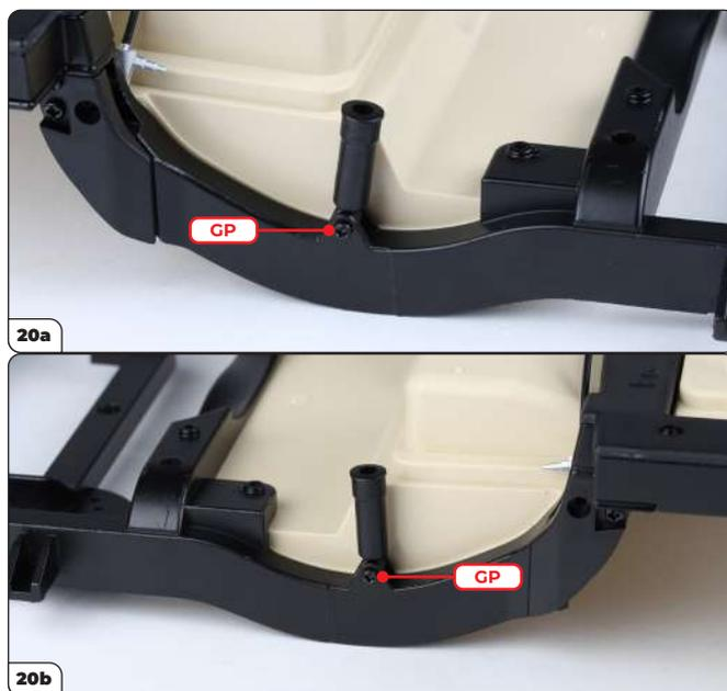
Asegure el cilindro con un tornillo GP (imagen 20a). Encaje el cilindro restante en el otro lado y asegúrelo con un tornillo GP (imagen 20b).
