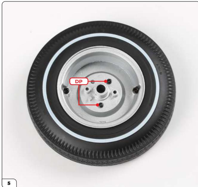
Desde el otro lado de la llanta, asegure el tapacubos usando 2 tornillos DP.
