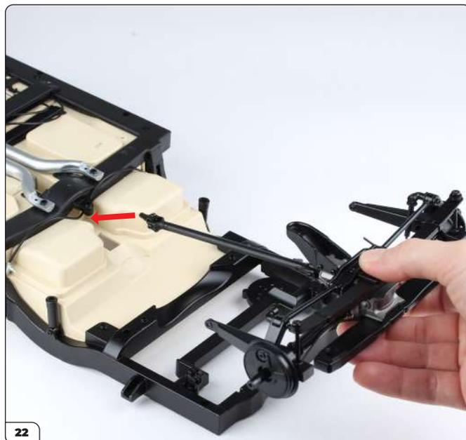
Alinee el montaje de la suspensión trasera con el chasis trasero, como se muestra en la figura. Encaje el extremo del eje de transmisión en el canal central del suelo del habitáculo (flecha).
