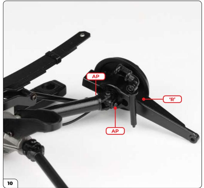
Acople la mangueta derecha siguiendo los mismos pasos anteriores y asegúrela usando 2 tornillos AP.
