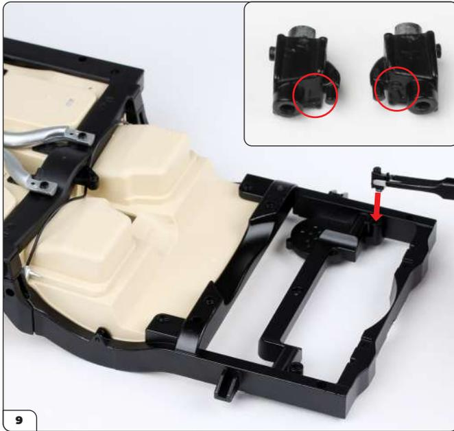
Los soportes de los tubos de escape están marcados con una 'L' (izquierdo) y con una 'R' (derecho) (recuadro, rodeadas con un círculo). Encaje el soporte izquierdo, 'L', en el chasis trasero (flecha).
