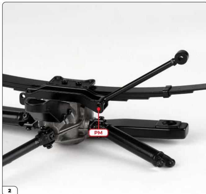
Asegure la barra oscilante al montaje usando un tornillo PM.
