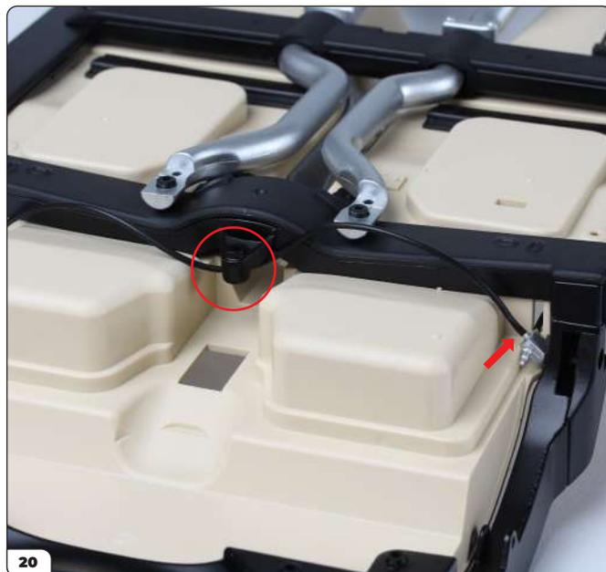
Fai passare il cavo sotto la sporgenza del telaio (cerchiata) e collega l'altra estremità al perno superiore del connettore sinistro (freccia).
