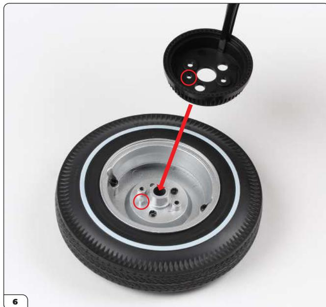
Monta il tamburo del freno posteriore destro sul cerchione esterno della ruota utilizzando il perno di bloccaggio e il foro per allineare correttamente le parti.
