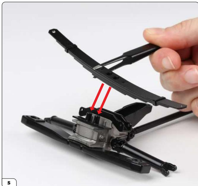
Monta molle a balestra sul posto di fissaggio con l'orientamento indicato (freccie).
