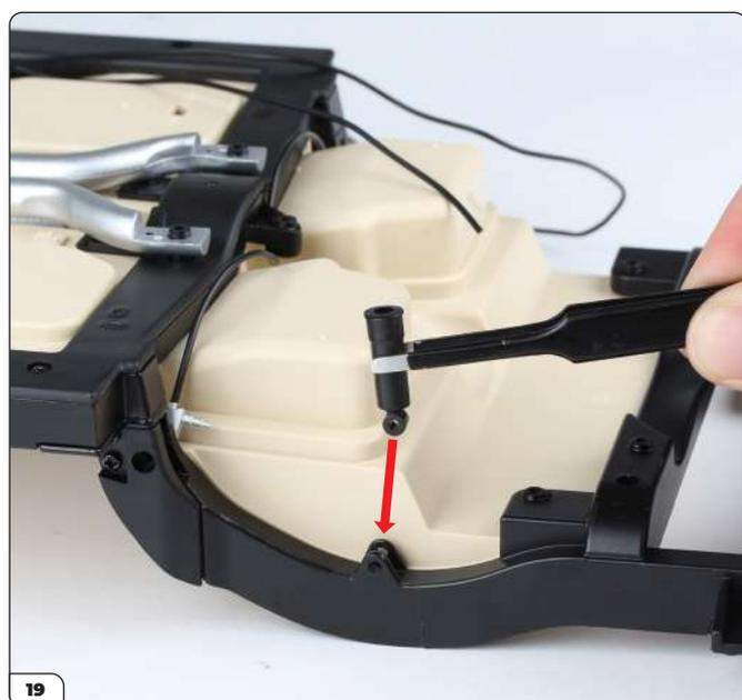
Inserisci un cilindro dell'ammortizzatore posteriore nel telaio posteriore come indicato (freccia).
