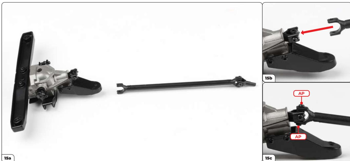
Unisci l'albero di trasmissione (fase 23) alla scatola del differenziale posteriore (15a). Monta il connettore sul giunto centrale (15b, freccia) e fissa con 2x viti AP (15c).
