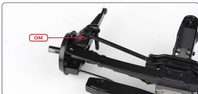
Inserisci le estremità grandi della barra oscillante inferiore nei braccetti inferiori e fissale con una vite OM.
