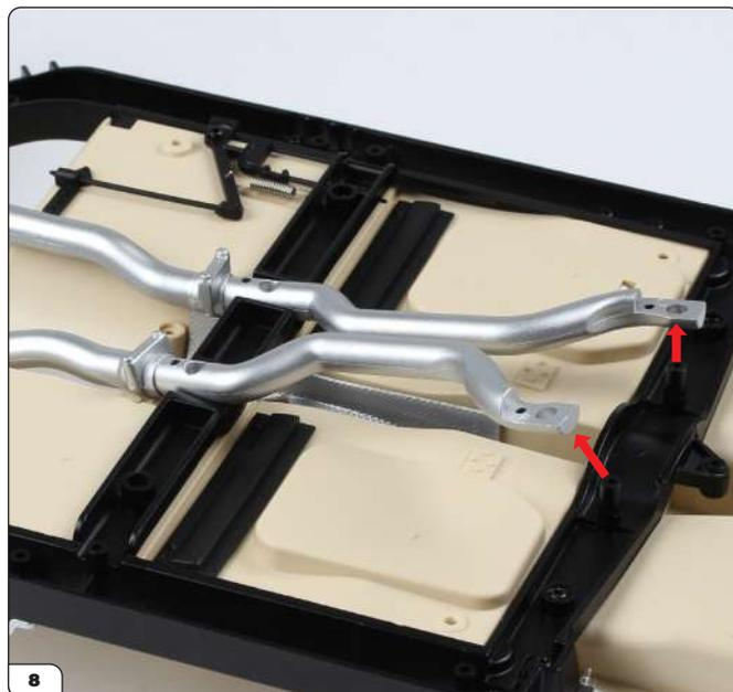
Solleva delicatamente le estremità dei tubi di scarico dalle viti del telaio (freccie).
