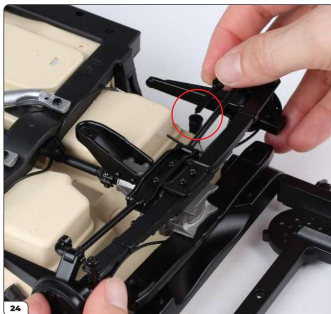
Durante il montaggio del gruppo, guida le aste dell'ammortizzatore nei cilindri (cerchiati).
