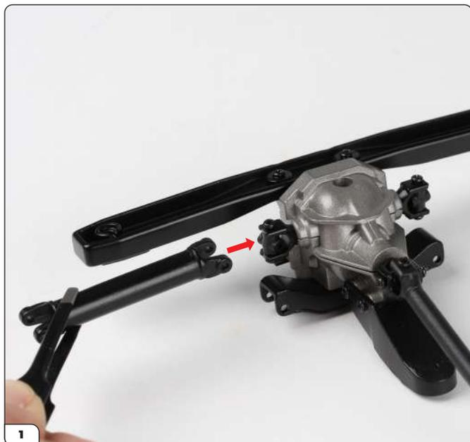
Posiziona l'estremità di un albero di trasmissione dell'asse sul giunto del differenziale posteriore come indicato (freccia).
