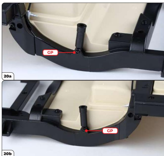
Fissa il cilindro con una vite GP (20a). Monta il cilindro rimanente sull'altro lato e fissalo con una vite GP (20b).
