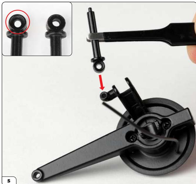
Posiziona l'ammortizzatore posteriore sul braccetto inferiore dello snodo sinistro (freccia). Nota che l'asta presenta un incavo su un lato (cerchiato nel dettaglio) che deve essere rivolto verso l'esterno del braccetto.
