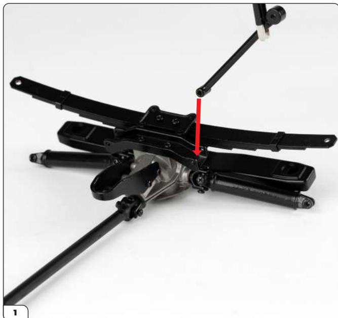
Inserisci l'estremità più piccola di una barra oscillante inferiore nella staffa del differenziale posteriore (freccia).
