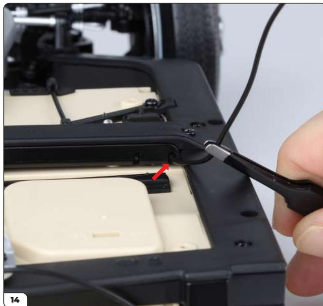
Inserisci il tubo lungo 145 mm nel perno 1.
