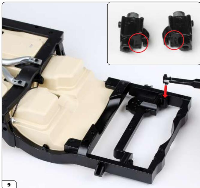
Le staffe del tubo di scarico sono contrassegnate con 'L' e 'R' (in figura, cerchiate). Monta la staffa 'L' sinistra sul telaio posteriore (freccia).
