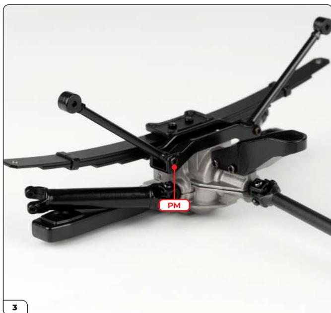
Monta l'altra barra oscillante inferiore e fissala con un vite PM.
