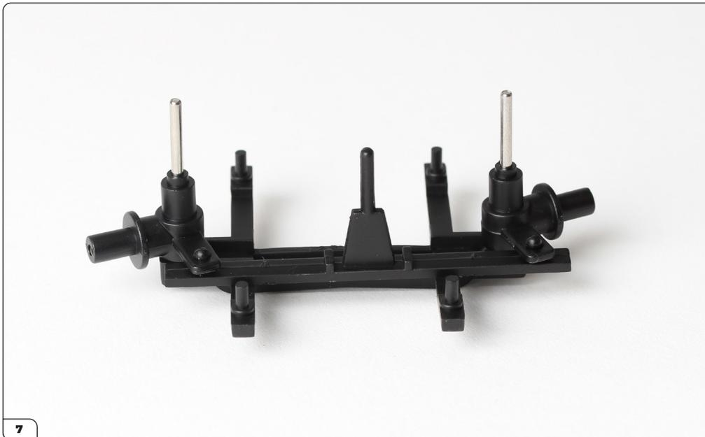
La barre d'accouplement est à présent montée, reliant les deux moyeux de roue.
