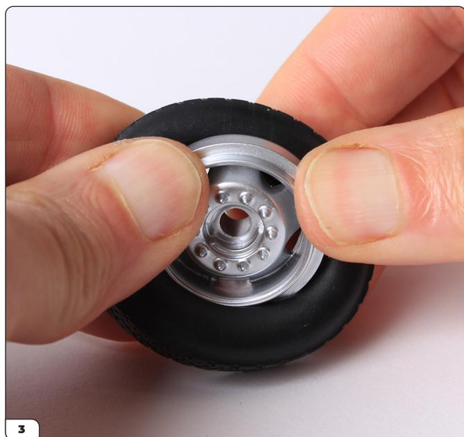
En procédant rapidement de façon à ce que le pneu soit encore chaud, poussez la roue dans le pneu et étirez-la autour du rebord extérieur de la roue.
