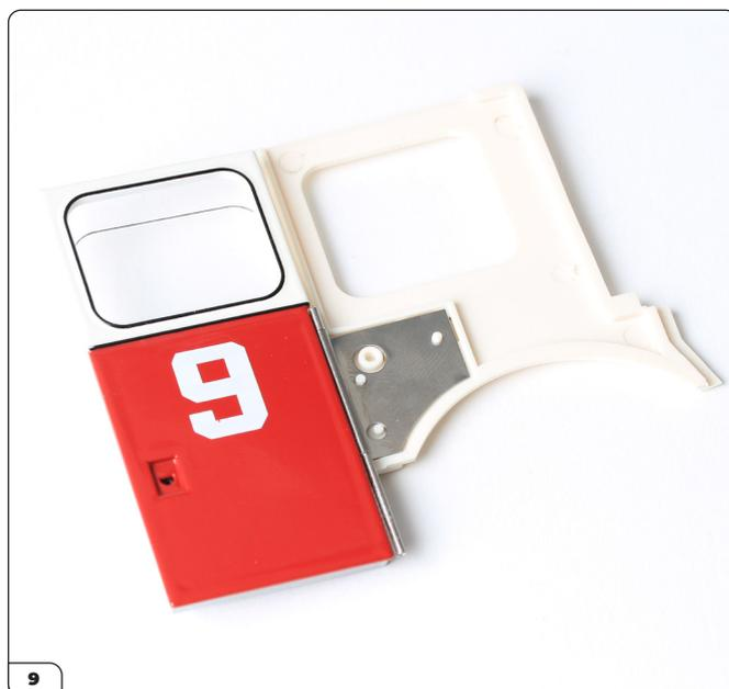
Alignez les quatre trous de la charnière de portière avec les quatre broches du panneau intérieur de la cabine. Appuyez fermement sur la charnière pour la mettre en place.
