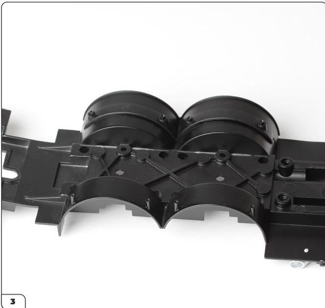
Appuyez fermement sur les passages de roue pour les mettre en place.
