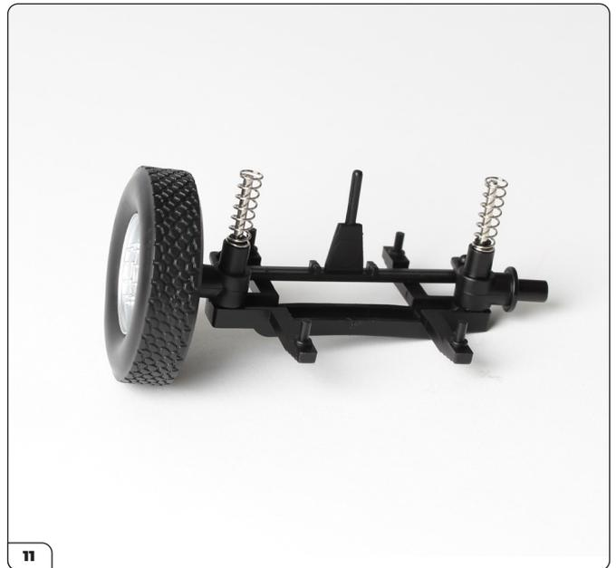
Passez les deux ressorts hélicoïdaux sur les montants de l'essieu.
