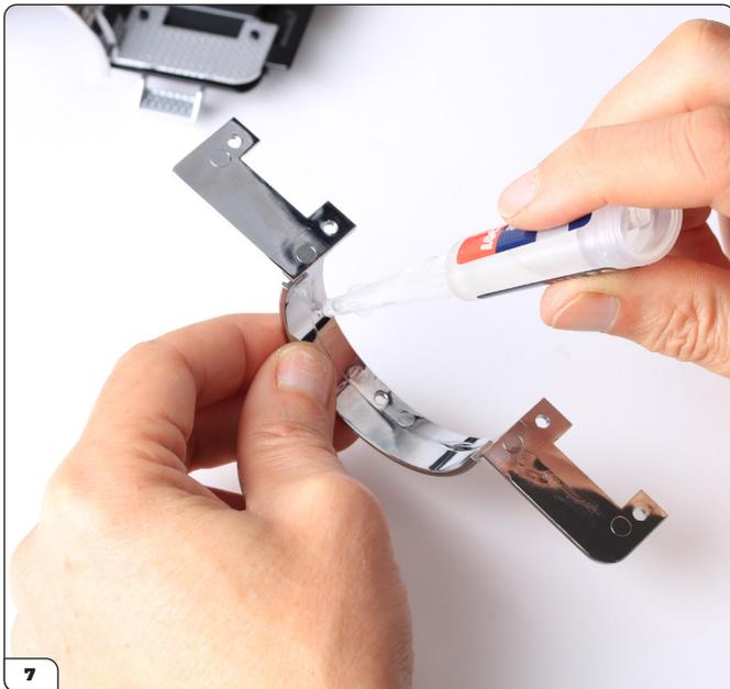
Le processus est similaire pour fixer les enveloppes de passage de roue chromées à l'avant du châssis. Commencez par tester le montage des pièces de chaque côté, puis appliquez un peu de colle sur la bride de l'enveloppe de passage de roue droite, là où elle sera en contact avec le châssis.
