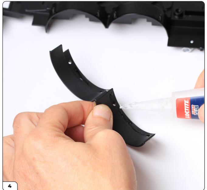
Répétez l'opération pour monter le deuxième passage de roue sur le côté droit du châssis. Testez le montage des pièces avant d'appliquer un peu de colle sur la bride.
