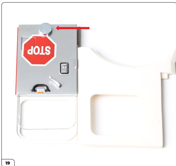
Si la ligne rouge n'est pas clairement visible sur l'aimant, vous pouvez vérifier quel côté de l'aimant doit être orienté vers l'extérieur sur le sol en le plaçant sur l'une des portières. Le côté comportant la ligne rouge doit coller à la portière.
