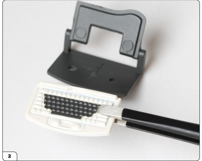
Alignez les chevilles situées sous le clavier avec les deux trous correspondants sur le cadre. Vérifiez que le clavier est correctement orienté (le bord plat devant être orienté vers l'arrière), puis enfoncez fermement les chevilles dans les trous.
