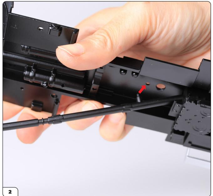
En même temps, alignez la cheville de l'extrémité avant de l'arbre de transmission avec le trou situé vers l'extrémité avant du châssis principal.
