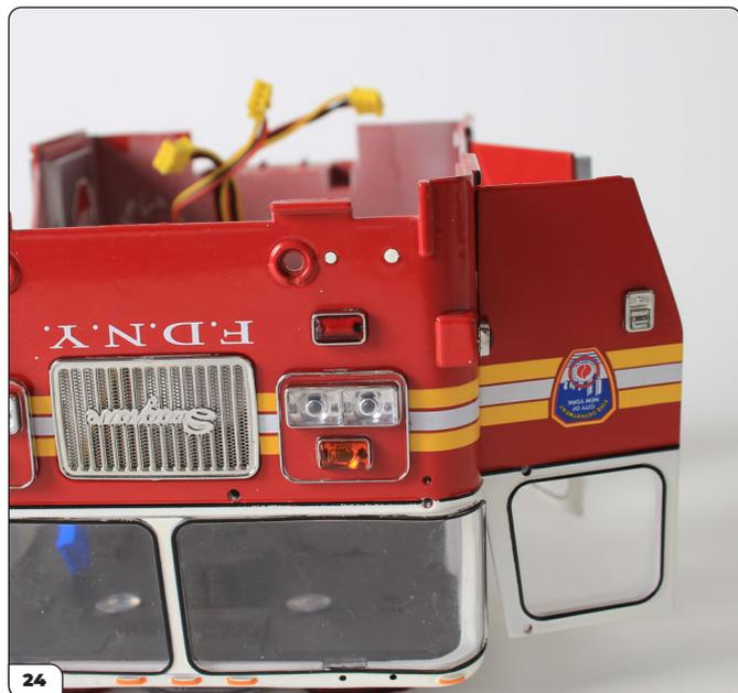
Montez un autre feu de secours en poussant fermement les languettes dans les petits trous de chaque côté de la vis.
