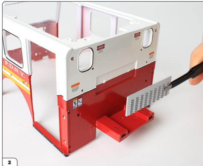
Alignez les languettes avec les trous du renforcement sur la paroi extérieure arrière de la cabine, en vérifiant l'orientation. Les trous de tailles différentes doivent correspondre.
