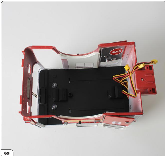
En vous assurant que les trois câbles se déploient au maximum et reposent bien à plat sous le toit, appuyez fermement sur le toit intérieur contre l'intérieur du toit de la cabine.
