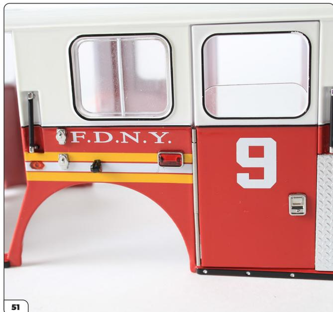
Montez l'un des feux de secours assemblés aux étapes 15-17 en poussant fermement les languettes dans les trous de chaque côté de la vis.
