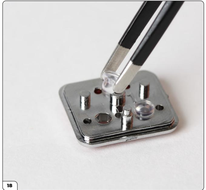
18 Répétez l'opération pour fixer le troisième diffuseur LED au bloc optique avant.
