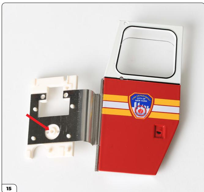
Alignez les quatre trous de la charnière de portière avec les quatre broches du panneau intérieur de la cabine. Assurez-vous que le pas de vis en saillie (cf. flèche) est positionné au centre du trou correspondant dans la charnière, avant de presser fermement la charnière et le panneau de cabine l'un contre l'autre.
