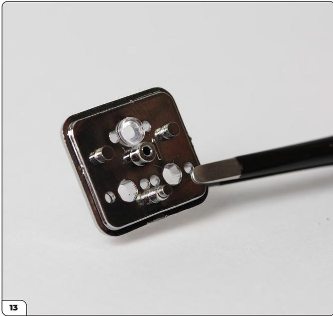
Poussez le bloc optique pour le mettre en position de sorte que la face bombée dépasse de l'autre côté.
