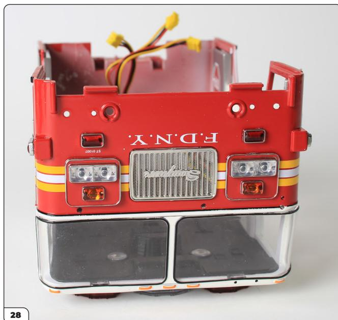
Montez le dernier feu de secours dans le corps principal de la cabine en poussant les languettes dans les trous de chaque côté de la vis de type C.
