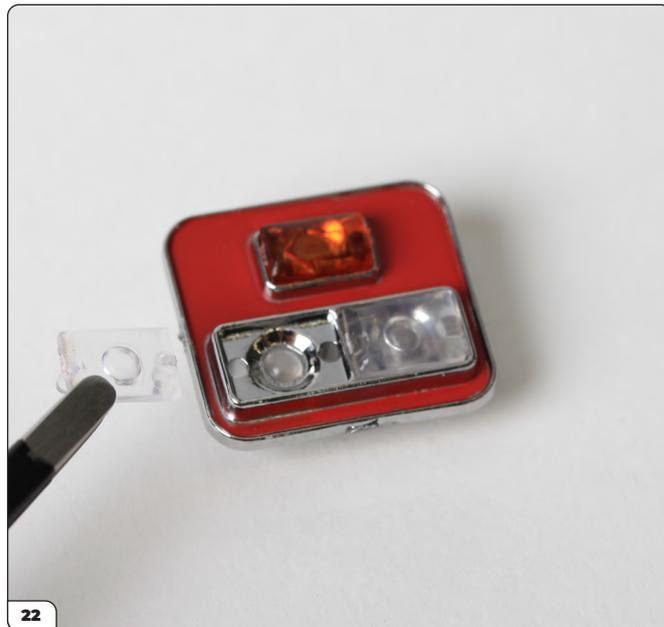
Répétez l'opération pour installer la deuxième lentille de phare sur le dernier diffuseur LED.
