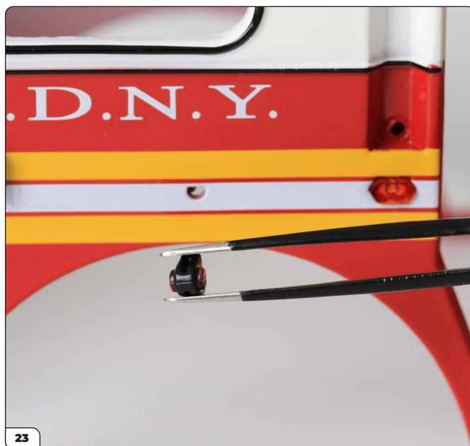
Installez une lanterne dans le trou situé à côté du réflecteur latéral. Le raccord en forme de D facilitera l'orientation. Remarque : la fente de la lanterne est orientée vers le haut. Ajoutez une goutte de colle pour consolider.
