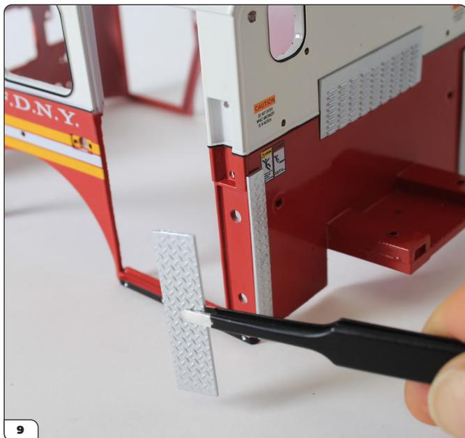
Alignez les languettes avec les trous correspondants sur le côté de la cabine, attendant à la paroi extérieure arrière.
