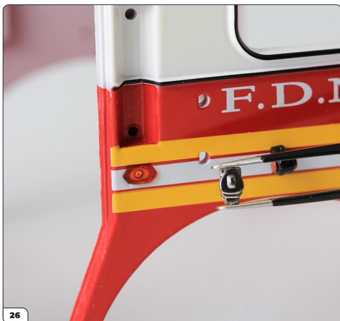
Les deux fiches d'alimentation se montent entre le réflecteur latéral et la lanterne, sur le côté gauche de la cabine. En tenant l'une des fiches avec une pince à épiler, alignez la languette en forme de D avec le trou inférieur dans le sens indiqué. Remarque : les deux fiches sont identiques et peuvent être montées indifféremment dans l'un ou l'autre trou.
