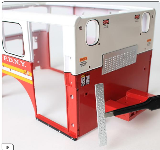
Alignez le panneau arrière de la cabine avec les trous situés sur le bord de la paroi extérieure arrière de la cabine.
