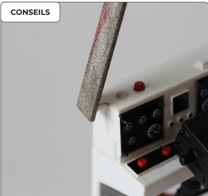
Le haut du tableau de bord doit être aligné avec le bord inférieur du pare-brise avant. Si vous avez du mal à l'insérer, essayez de limer les deux coins du tableau de bord.
