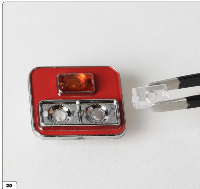
Retournez le bloc optique avant de sorte que sa face avant soit orientée vers le haut et alignez une lentille de phare par-dessus le diffuseur LED en saillie.
