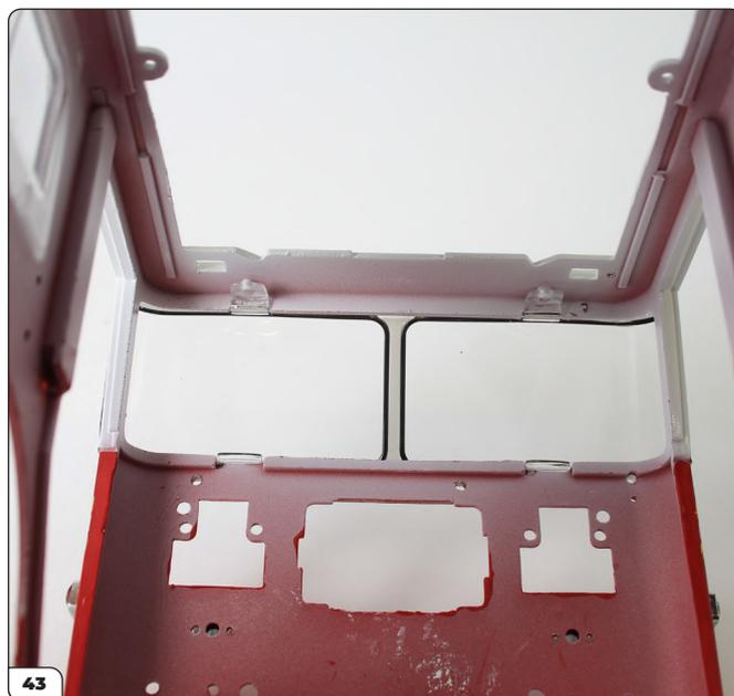
Vérifiez que les languettes du pare-brise sont correctement positionnées dans la cabine.
