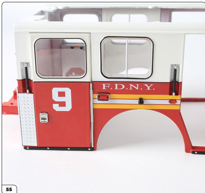
Montez un autre feu de secours en poussant fermement les languettes dans les trous de chaque côté de la vis. N.B. : les portières ne resteront probablement pas en position fermée tant que la base de la cabine ne sera pas montée, notamment avec les aimants qui maintiennent les quatre portières de la cabine en position fermée.
