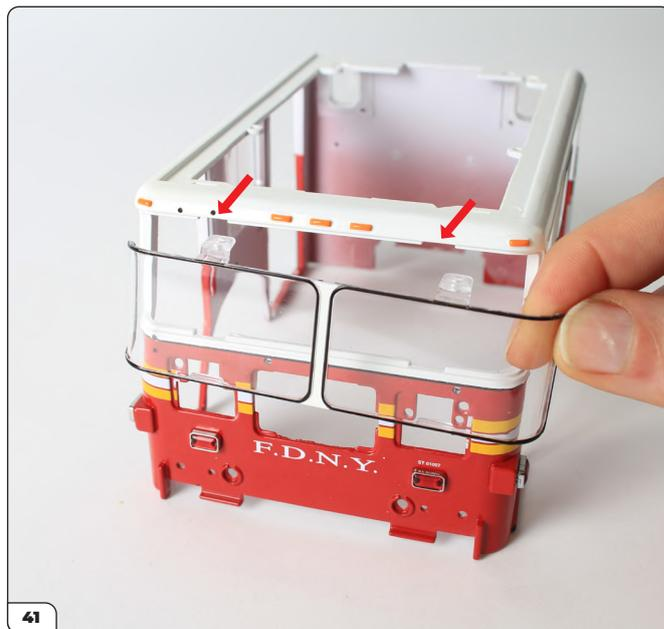
Positionnez le pare-brise avant devant la cabine, en alignant les languettes en haut du pare-brise avec les encoches du cadre de la cabine (cf. flèches).
