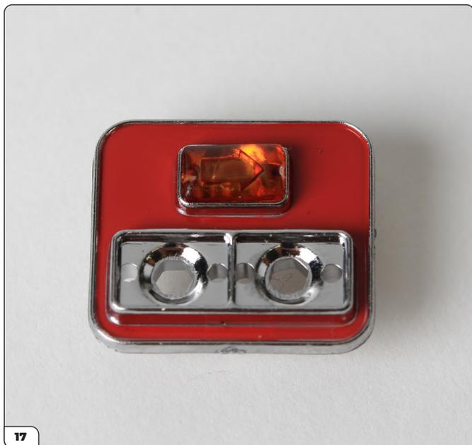
Placez la lentille du clignotant sur le diffuseur que vous venez d'assembler (photo 16), en vous assurant que la flèche est orientée dans le sens indiqué. Poussez fermement pour mettre en place.
