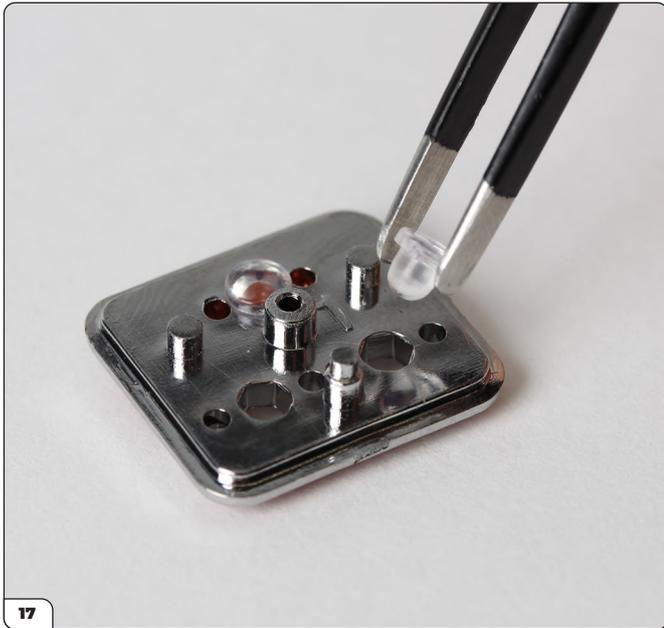
17 Prenez un autre diffuseur LED et insérez-le dans l'une des paires de trous inférieurs à l'arrière du bloc optique avant.
