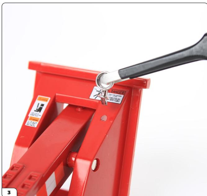
Alignez le feu d'éclairage au sol avec le trou en forme de D sur le stabilisateur. Le feu d'éclairage au sol doit bien évidemment être orienté vers le bas. Appliquez une goutte de colle sur la cheville du feu d'éclairage au sol.
