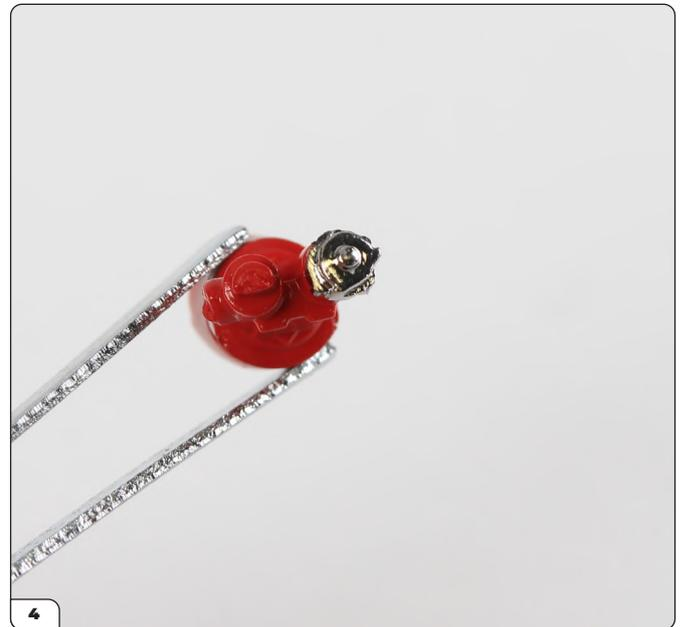
Poussez l'un des bouchons sur l'une des broches du raccord d'alimentation.
