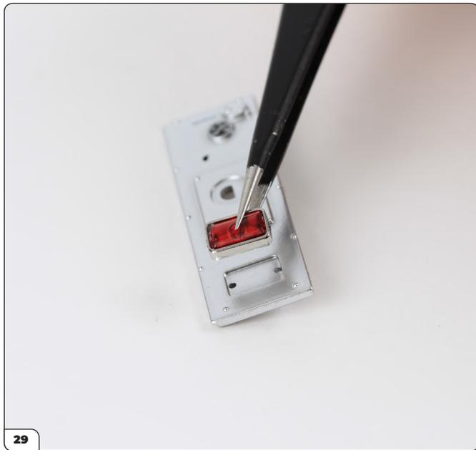
Le feu de secours droit se fixe horizontalement dans l'encoche du panneau d'arrivée d'eau droit.
