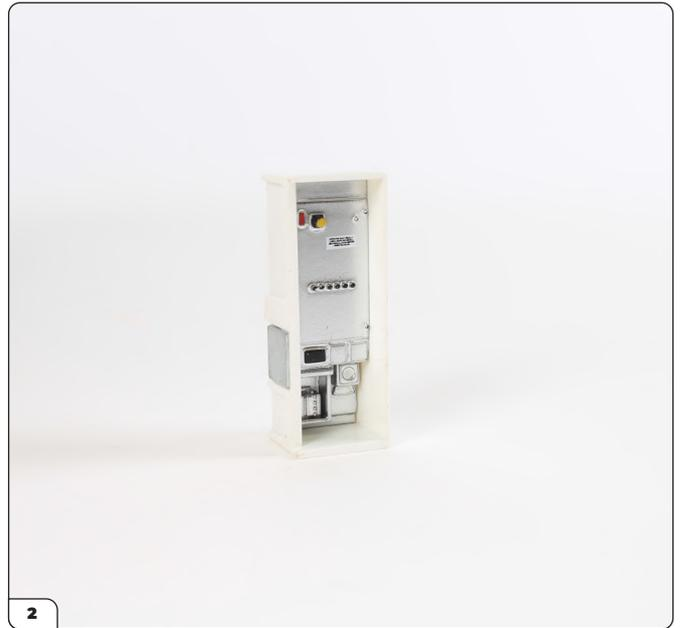
Appuyez sur le panneau électrique pour le mettre en place à l'intérieur du compartiment électrique, jusqu'à ce que les broches du verso soient fermement insérées dans les trous correspondants.
