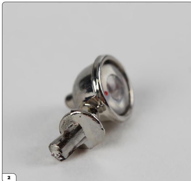
Poussez fermement sur la lentille pour la mettre en place. Il pourra être nécessaire d'appliquer une petite goutte de colle PVA (qui a la particularité de rester transparente une fois sèche) pour maintenir la lentille en place.
