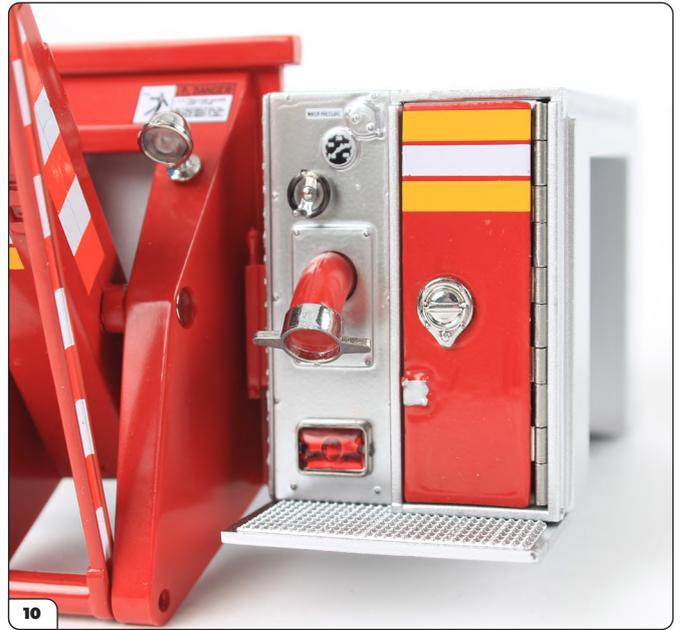
Poussez le compartiment électrique dans la section médiane de la carrosserie, jusqu'à ce que les pattes s'insèrent fermement dans les trous de fixation.
