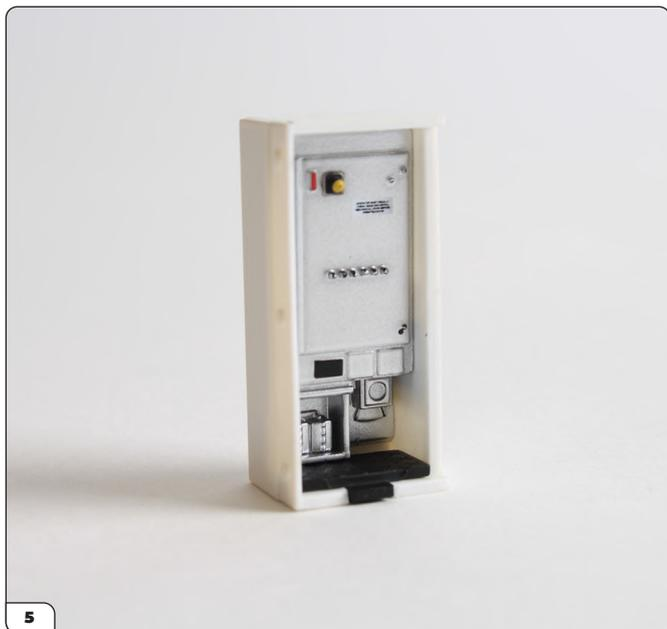
Appuyez sur le panneau électrique pour le mettre en place à l'intérieur du compartiment électrique, jusqu'à ce que les broches du verso soient fermement insérées dans les trous correspondants.
