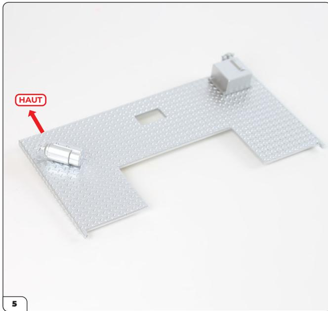
Fixez le détail de bidon de la même manière sur le côté opposé du panneau. Vérifiez à nouveau que le bidon est orienté en diagonale et vers le haut, tel qu'indiqué sur la photo.
