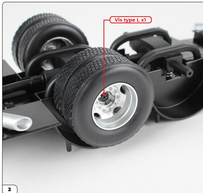
Poussez la roue sur l'essieu et fixez avec une vis de type L.
