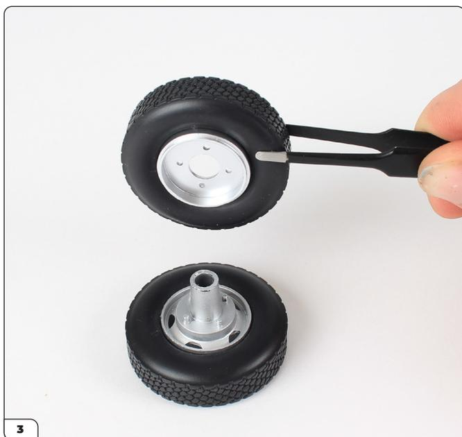
Appliquez une goutte de colle sur la surface plane de la roue intérieure, puis alignez-la avec les quatre broches de fixation de la roue extérieure, avant de presser les deux roues l'une contre l'autre. Appuyez fermement.
