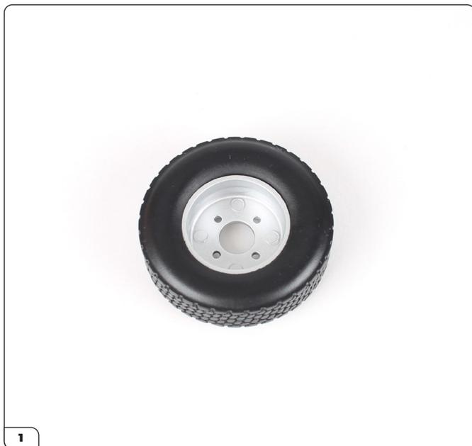
Après avoir trempé le pneu dans l'eau chaude pendant une minute, poussez la roue intérieure dans le pneu de sorte que la jante s'insère parfaitement dans la rainure.
