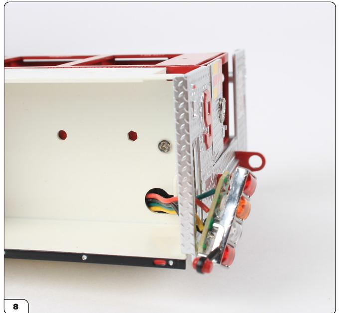
Tirez le câble au maximum jusqu'à ce que le circuit imprimé soit maintenu contre le panneau arrière. Poussez ce côté gauche du panneau arrière pour le mettre complètement en place sur le cadre du boîtier, mais laissez le côté droit détaché (voir photo suivante).
