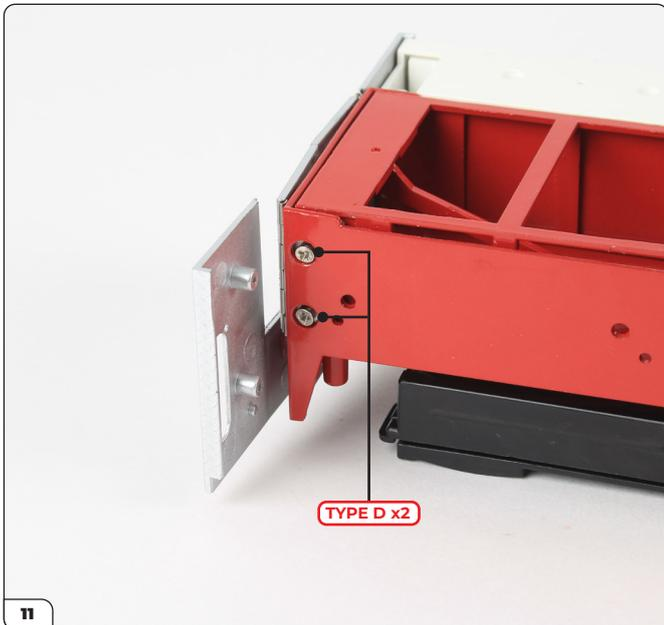
Avec la porte en position fermée, fixez-la à l'aide de 2 vis de type D, en les insérant depuis l'extérieur.
