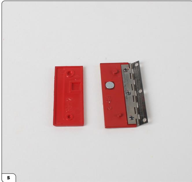
Répétez l'opération pour assembler les parties avant et arrière de la porte droite. Vérifiez à nouveau que les renforcements carrés pour l'aimant sont correctement alignés sur les deux parties.
