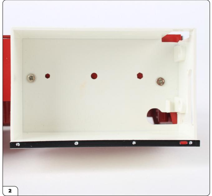
Fixez le compartiment à l'aide de 2 vis de type D. Appliquez une goutte de colle à l'extrémité de chaque vis avant de l'insérer.
