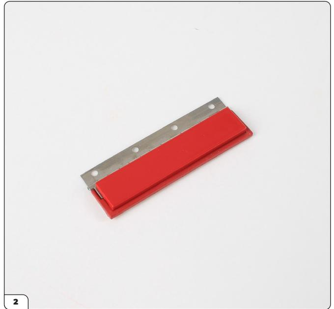
Appliquez de la colle, puis poussez fermement les pièces l'une contre l'autre jusqu'à ce que les quatre côtés soient à niveau.
