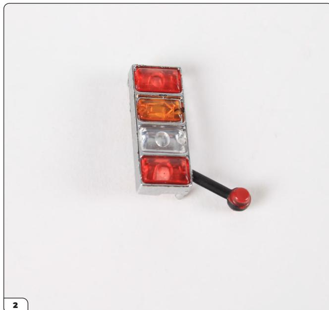
Les feux arrière fonctionnent comme suit : (de bas en haut) LED rouge inférieure = feu d'avertissement ; LED claire = éclairage de secours ; LED orange = feu de signalisation ; LED rouge supérieure = feu de freinage/feu arrière.
