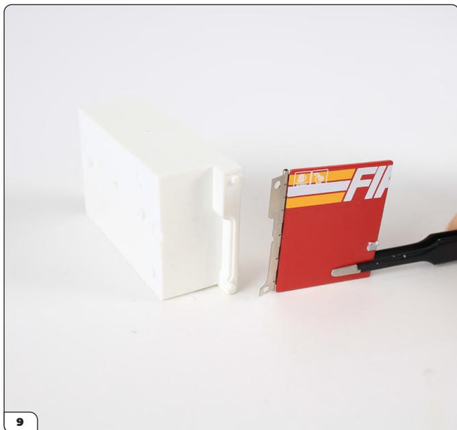
Prenez l'intérieur du compartiment et notez que les différentes formes des charnières correspondent aux formes des supports de charnière sur le compartiment. Appliquez un peu de colle sur le support de charnière. Installez la charnière sur le support, en vérifiant que la portière se ferme correctement.
