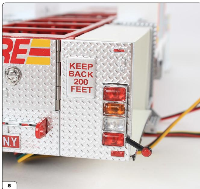
Tirez le câble au maximum jusqu'à ce que le circuit imprimé soit maintenu en place contre le panneau arrière. Poussez fermement sur le bloc optique jusqu'à ce qu'il soit à niveau.
