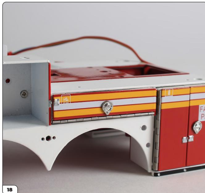
Poussez sur le compartiment pour le mettre en position.
