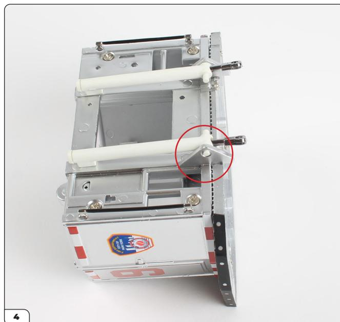
Répétez l'opération avec le second piston pour le fixer au niveau du point de fixation triangulaire opposé (entouré la photo).
