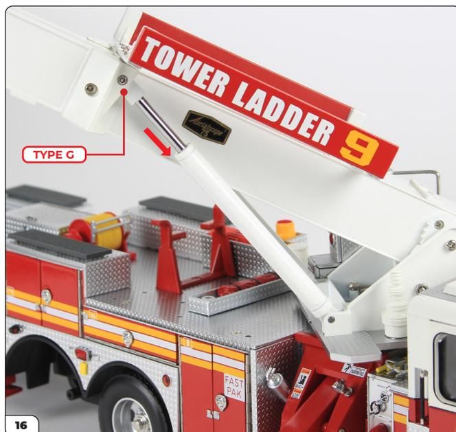
Faites glisser le piston restant de l'étape 47 dans son tube. Fixez l'extrémité libre du piston sur son support avec une autre vis type G.
