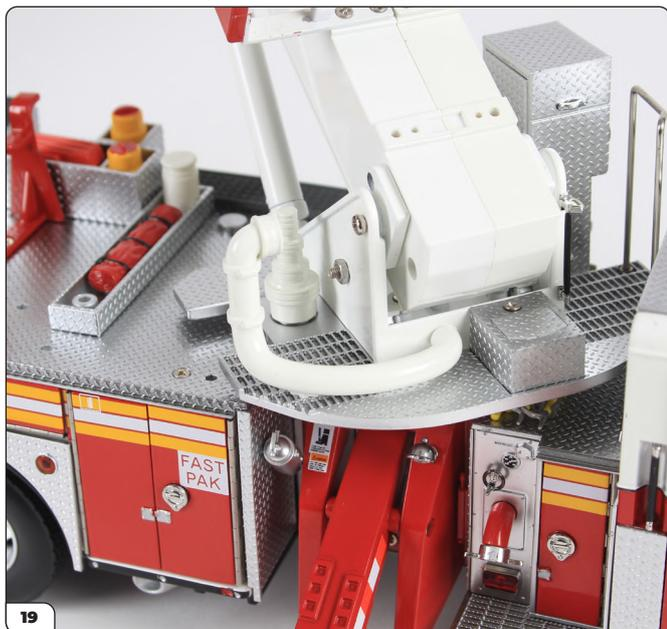
Poussez la conduite d'eau sur les points de fixation dans le sens indiqué.
