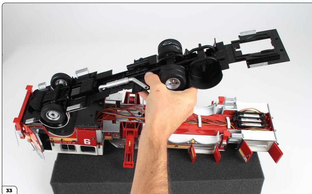
Abaissez le châssis sur le corps principal, en commençant par l'extrémité avant. Le bord avant doit s'accrocher autour de deux supports sous le pare-chocs avant (cf. étape 34).
