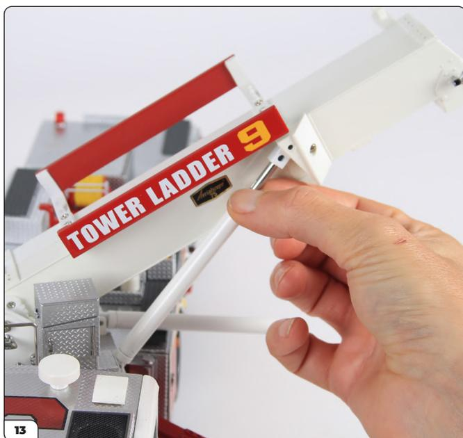
Insérez l'extrémité libre du piston dans le support de piston.
