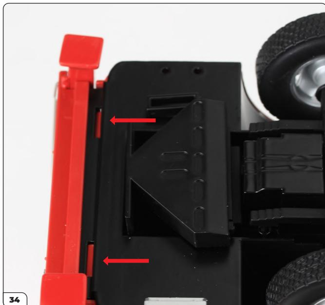
Une fois le bord avant accroché autour des supports indiqués à l'étape 34, abaissez le châssis sur le corps. La cheville indiquée à l'étape 31 doit s'engager dans le trou du support de direction.
