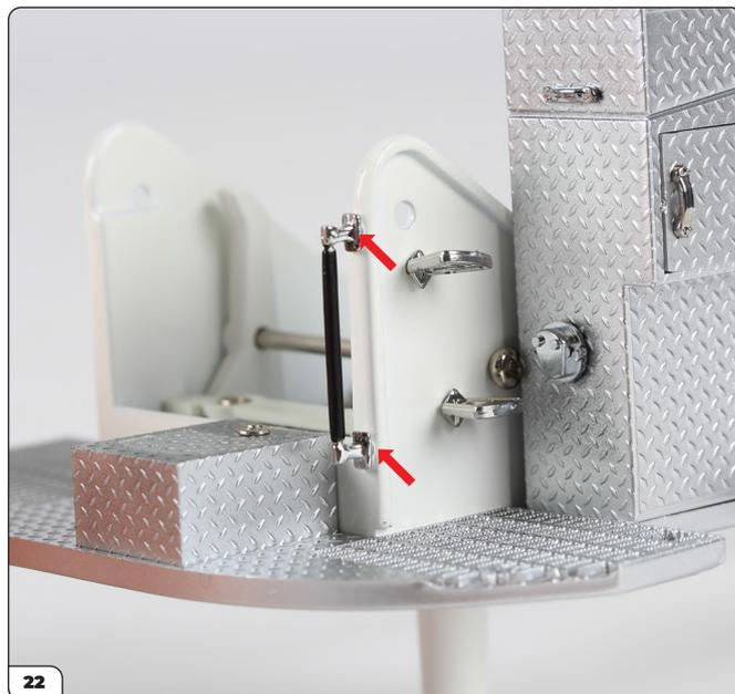
Poussez sur la main courante pour la mettre en position sur le bord étroit du support de flèche.
