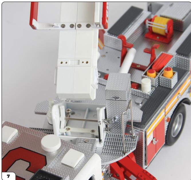
Vous pouvez à présent fixer la première section de flèche à son support. Commencez par abaisser l'extrémité de la section de flèche avec les pignons dans les supports de flèche.
