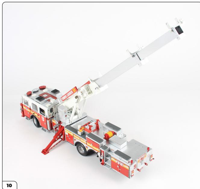
10 Les sections médianes inférieure et supérieure sont désormais fixées sur la plage. Poussez doucement mais fermement pour télescoper les sections intermédiaires dans la plage.
