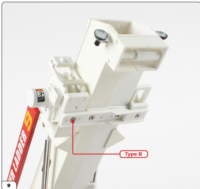
Fixez le support de l'enrouleur sur le soutien à l'aide d'une vis de type B.
