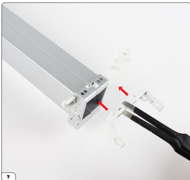
Prenez le guide-échelle de l'étape 64 et alignez ses broches de fixation avec les trous situés à l'extrémité de la section médiane supérieure.
