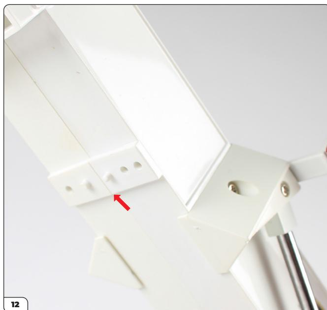
L'assemblage de l'étape 11 sera monté sur la face inférieure de la flèche aux points de fixation indiqués.
