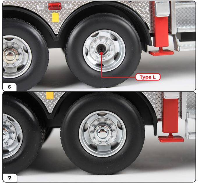
Fixez les roues au moyeu avec une vis L (fournie avec cette étape).
