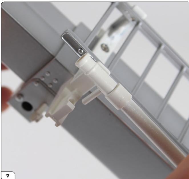
Ancrez l'extrémité supérieure du tuyau dans le support d'échelle en enfonçant la broche dans le trou correspondant.
