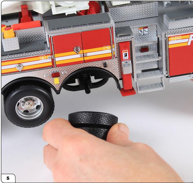
Vous allez à présent monter l'autre roue arrière sur le côté gauche. La roue extérieure étant face à vous, faites glisser les roues sur le moyeu.
