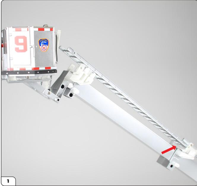
Vérifiez que l'échelle est correctement orientée, les pas de vis étant orientés vers le haut, puis insérez l'extrémité inférieure sur le support d'échelle situé sous la section d'échelle précédente.
