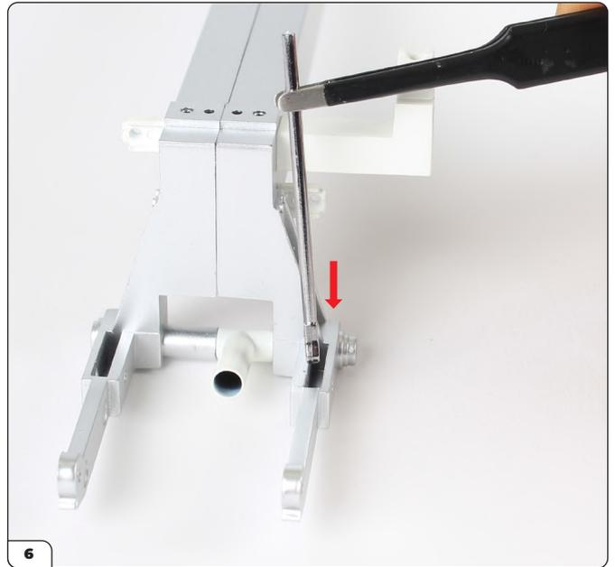
Alignez le pas de vis sur l'extrémité plate de l'un des pistons avec le pas de vis à l'intérieur du bras en saillie de la section aérienne.
