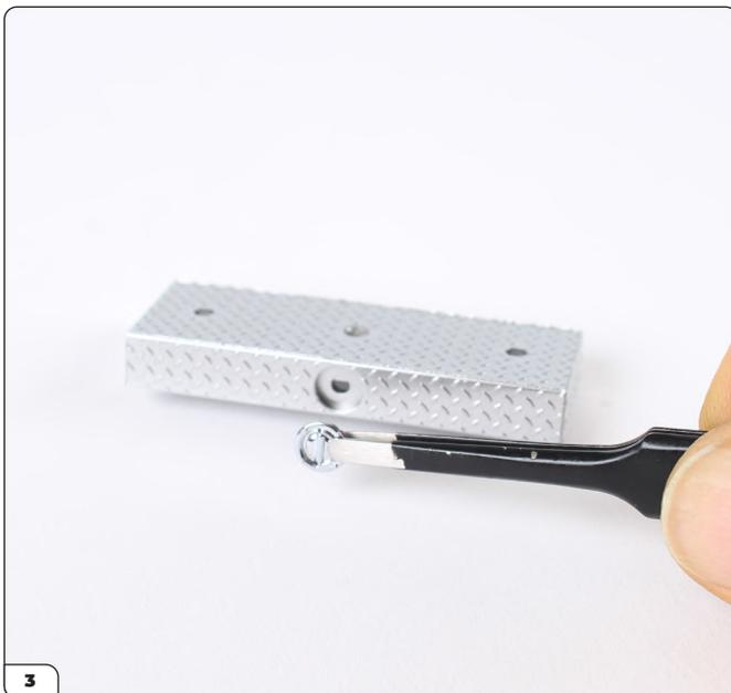
Les trois trous du compartiment de rangement étant orientés vers le haut, alignez les points de fixation en forme de D de la poignée et du compartiment.
