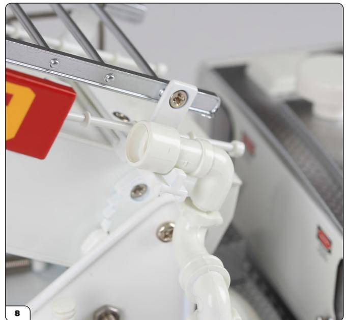
Ancrez le tuyau b en poussant son axe dans le petit trou du support de l'échelle.
