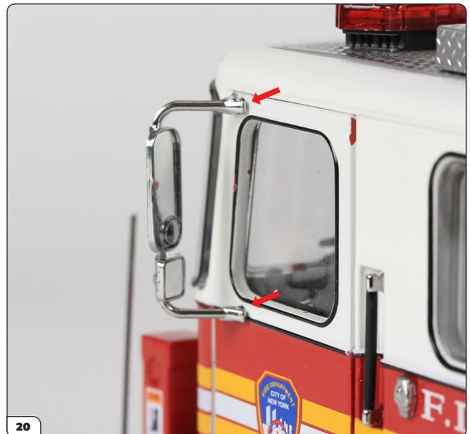
Répétez l'opération du côté gauche, pour fixer le rétroviseur extérieur du conducteur.
