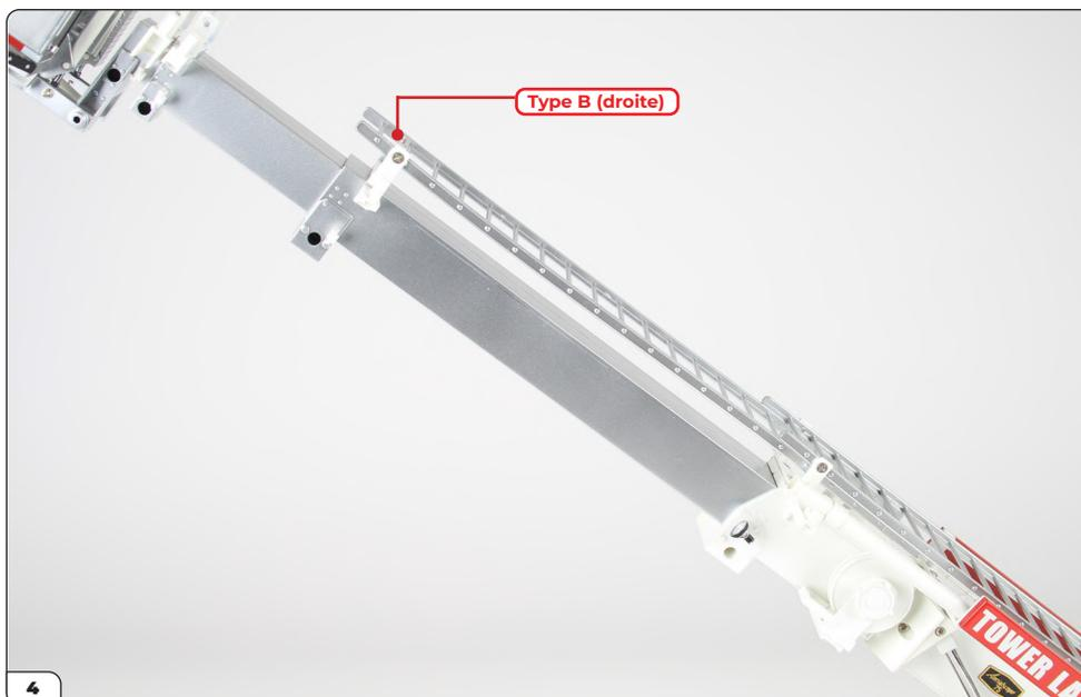
Déployez l'échelle jusqu'à ce que les pas de vis de l'extrémité supérieure soient alignés avec le support d'échelle de la section médiane inférieure. Fixez l'échelle sur le support avec 2 vis B (fournies dans le paquet de pièces détachées).
