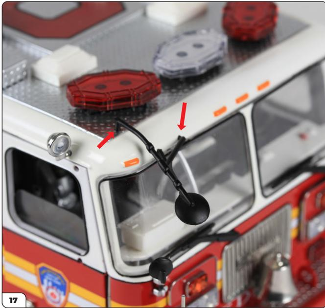
Le miroir du pare-chocs avant de l'étape 12 se fixe sur le toit, au-dessus du pare-brise droit.
