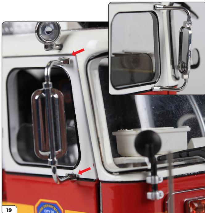
Fixez le rétroviseur extérieur droit en l'enfonçant fermement dans les deux points de fixation indiqués ci-dessus.
