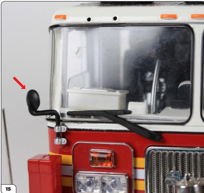
Prenez le rétroviseur de l'étape 20 et fixez-le juste en-dessous du pare-brise sur le côté droit.
