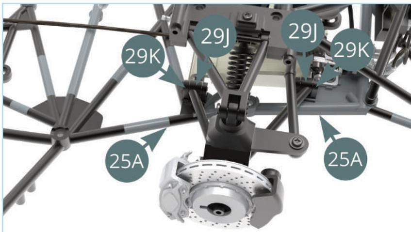
Aligner les deux supports de triangle inférieur 29K sur les logements situés en haut à droite du châssis inférieur 25A.
