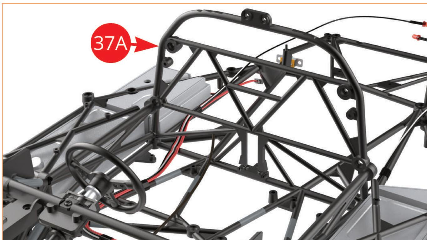
*Cloison de séparation du cockpit 37A installée sur le châssis.*
