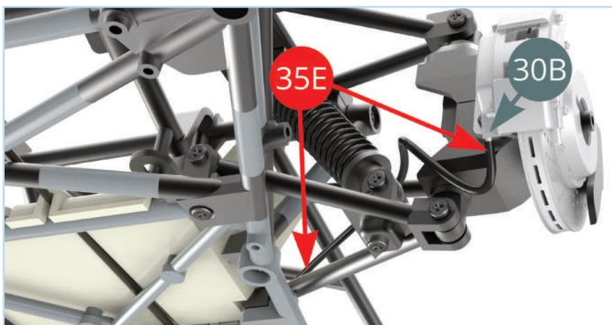
Positionner la durite de frein droit 35E sur le téton situé sous le cache-pistons de frein 30B. Guider l'autre extrémité de la durite 35E vers le maître-cylindre 26H.
