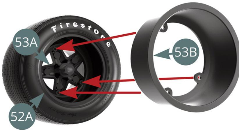
Positionner la jante intérieure 53B de l'autre côté du pneu en alignant correctement les trois points de fixation.
