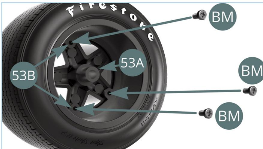
Fixer ensemble la jante intérieure 53B et la jante extérieure 53A avec trois vis BM.
