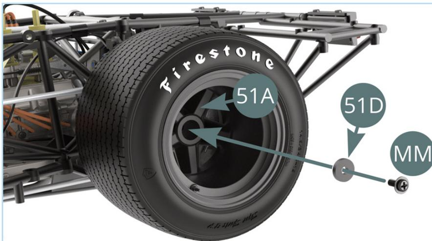
Fixer la jante extérieure de la roue arrière gauche 51A avec une vis MM en la passant préalablement dans la rondelle 51D.
