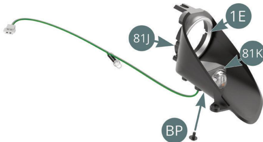
Positionner le boîtier de petit phare (L) 81K sur le nouveau boîtier de phare gauche 81J et le fixer avec une vis BP. Positionner l'enjoliveur de grand phare 1E sur le boîtier de phare gauche 81J.
